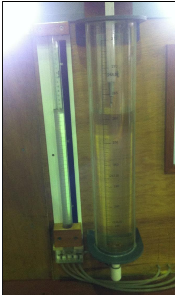
Figura 4.5. Piezómetros de medición complementarios
