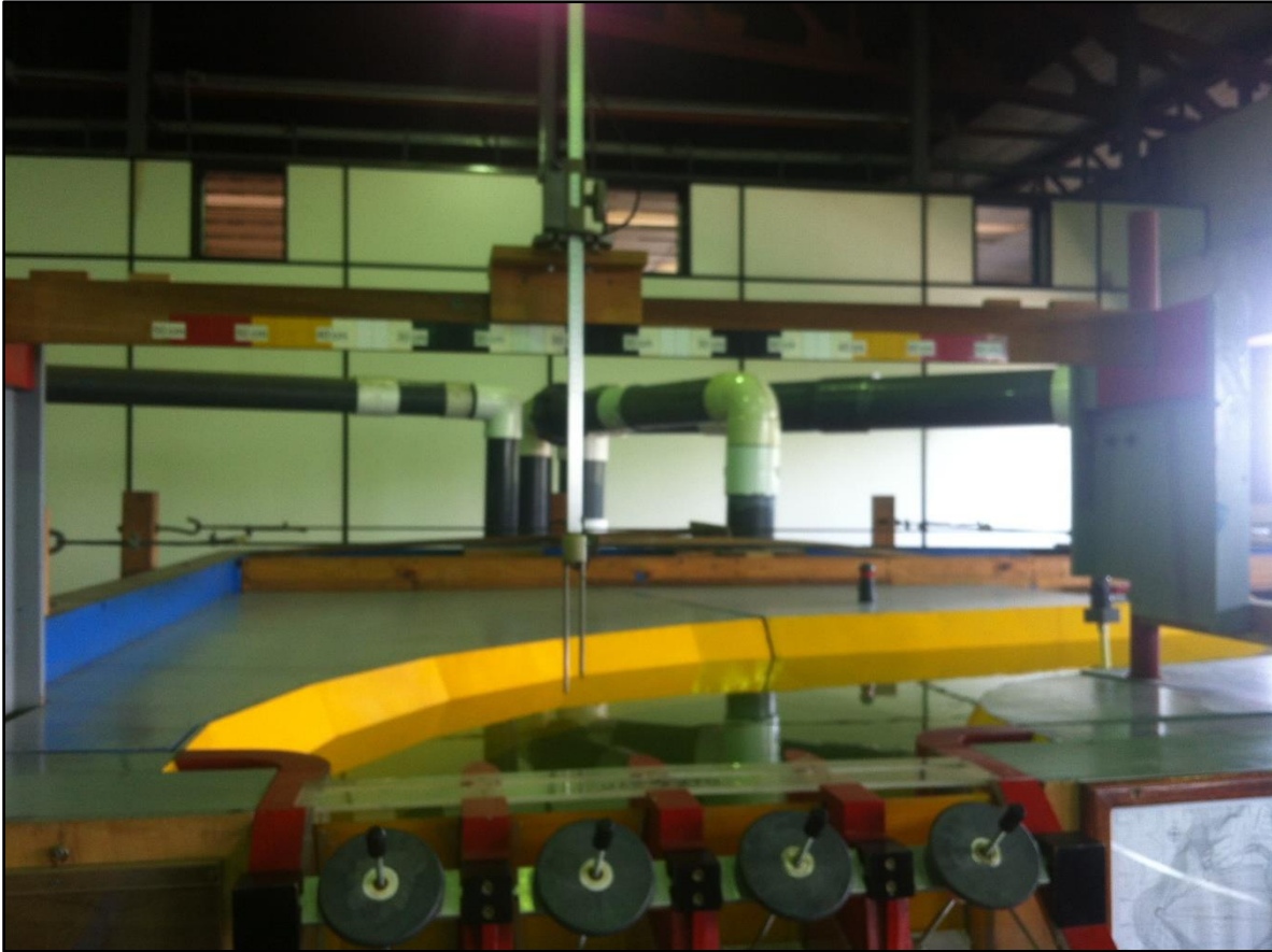
Figura 4.4. Limnómetro utilizado para la medición de niveles en la entrada al vertedero
