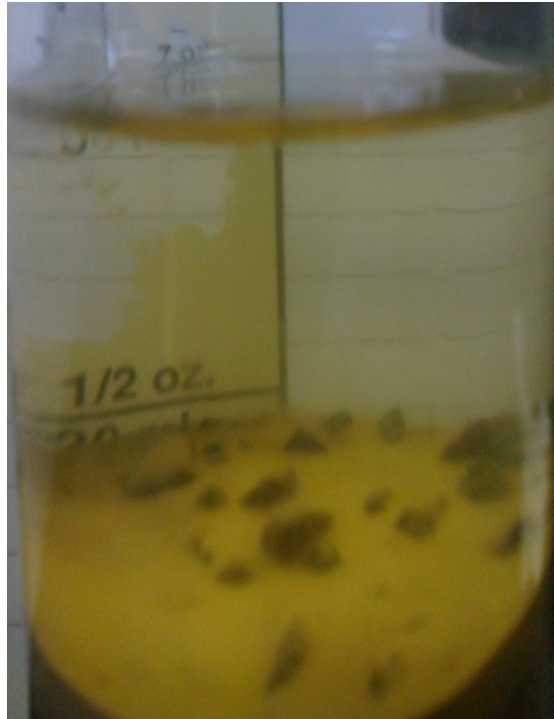
Figura 30. Ensayo materia orgánica en el agregado fino para la mezcla 2.
