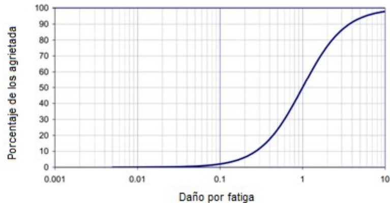
Figura 8. Relación entre el daño por fatiga y el agrietamiento de losa agrietada en JPCP.
