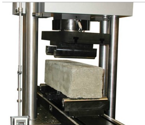
Figura 7. Montaje de ensayo a flexión
