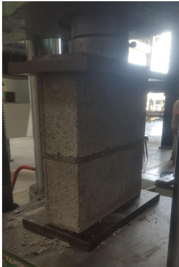
Figura 17. Falla de los prismas de mampostería
