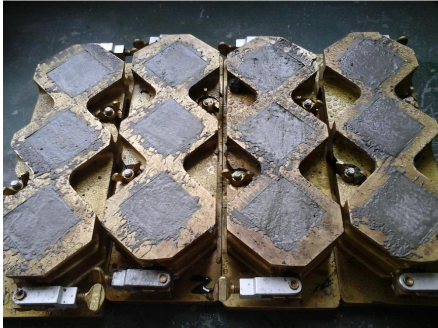
Figura 10. Moldeado de los cubos de mortero, arena de río lavada
