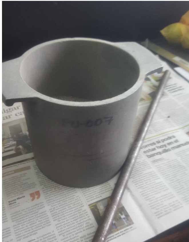
Figura 8. Equipo utilizado para la determinación del peso unitario suelto y envarillado de la arena
