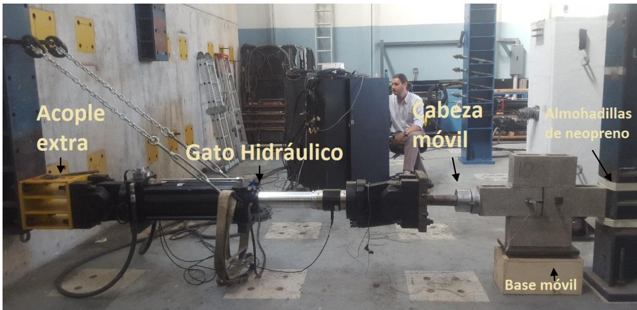
Figura 19. Montaje realizado para la falla de las cruces de mampostería
