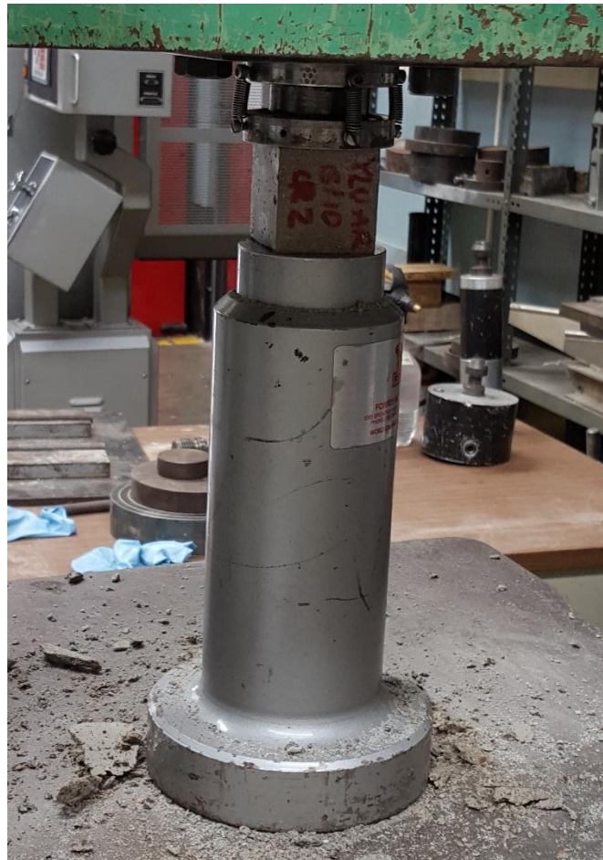
Figura 13. Falla de los cubos de mortero, equipo utilizado: SATEC
