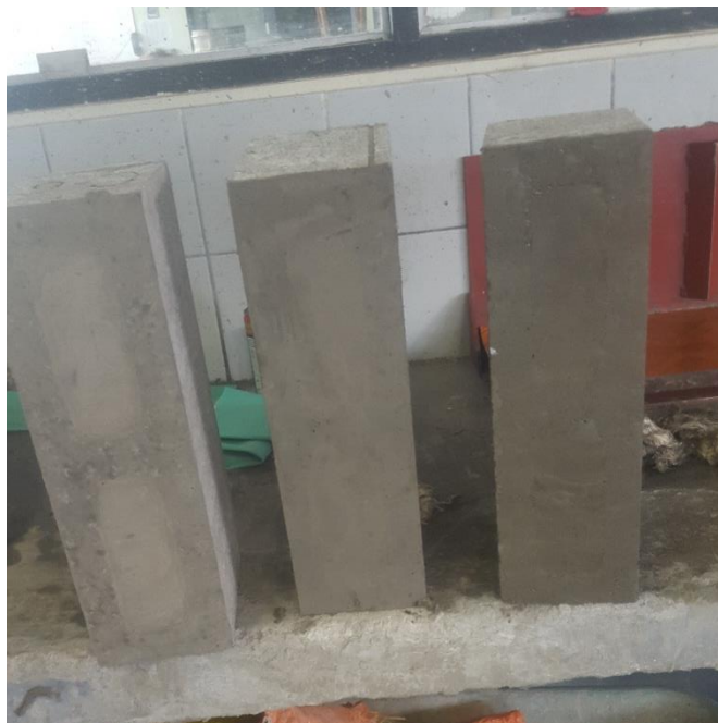
Figura 16. Bloques de concreto coronados para la prueba de resistencia a la compresión simple
