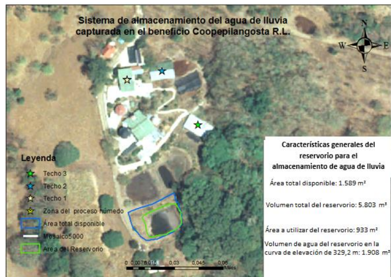
Figura 22. Área del reservorio para el almacenamiento del agua de lluvia
