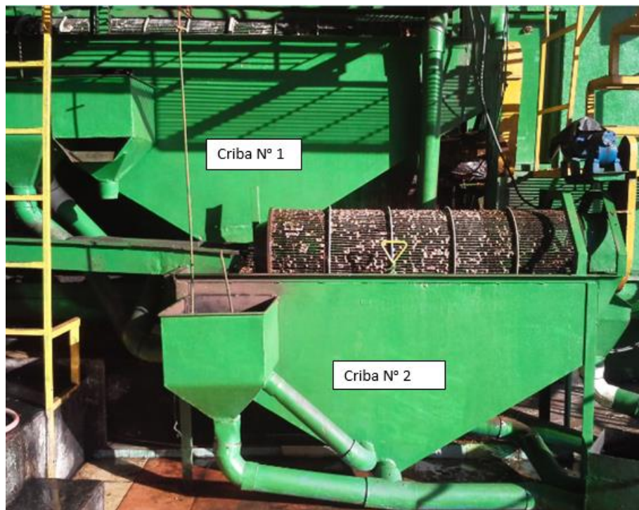
Figura 12. Cribas utilizadas en el beneficio Coopetilangosta R.L.
