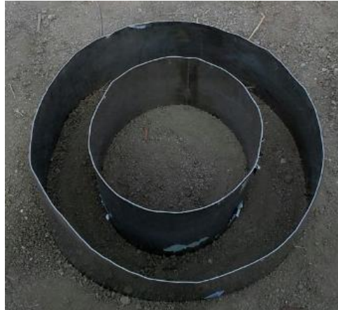
Figura 7. Anillos de Infiltración
