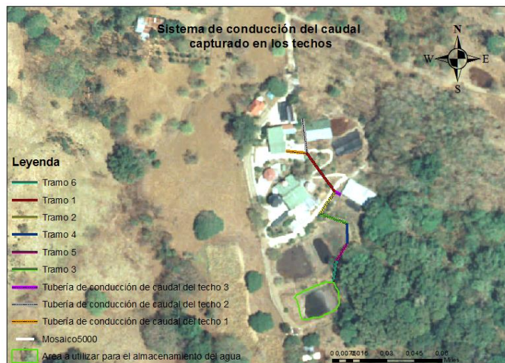
Figura 28. Sistema de conducción por gravedad
