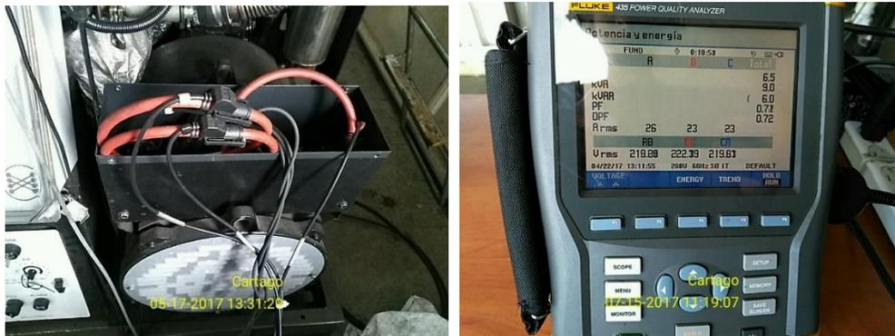
**Figura 5.18.** (a) Instalación de sensores de corriente y tensión (b) Interfaz de Fluke al realizar mediciones continuas de potencia y energía
