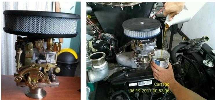
**Figura 5.19.** Carburador empleado como instrumento de limpieza del motor
