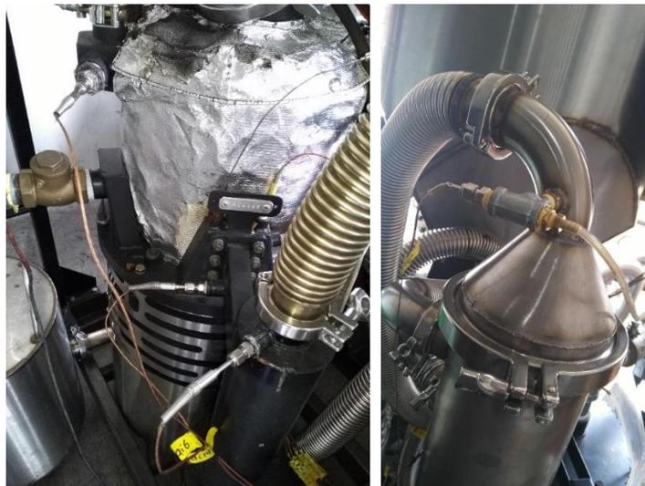
**Figura 5.10.** Instalación de termocuplas en la planta piloto
