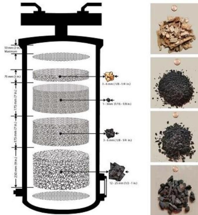
**Figura 6.19.** Configuración del relleno del filtro según fabricante
