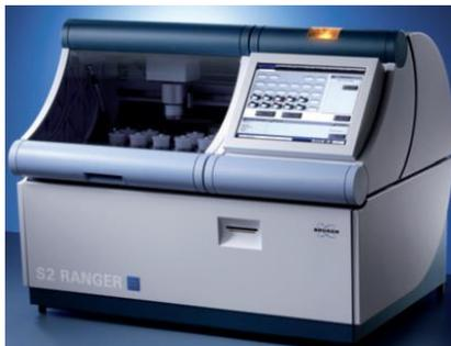
**Figura E.1.** Espectrómetro de fluorescencia de rayos X de dispersión de energía S2 Ranger empleado para la determinación del contenido de metales (Ranger, 2015)
