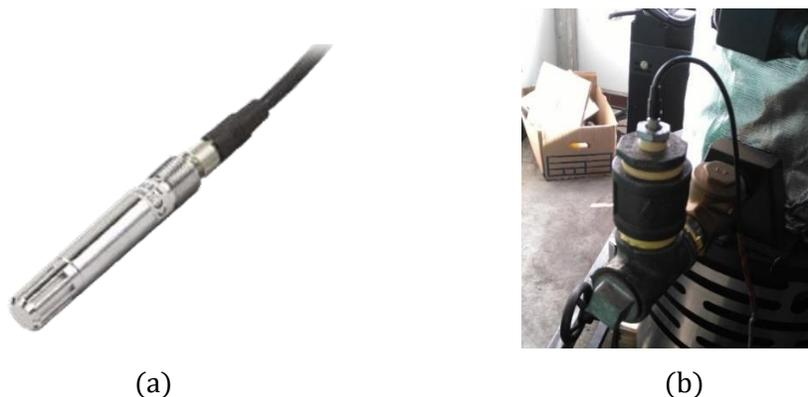
**Figura 5.3.** (a) Sensor de humedad relativa y temperatura ambiente Vaisala HMP110 (b) Instalación del sensor en la línea
