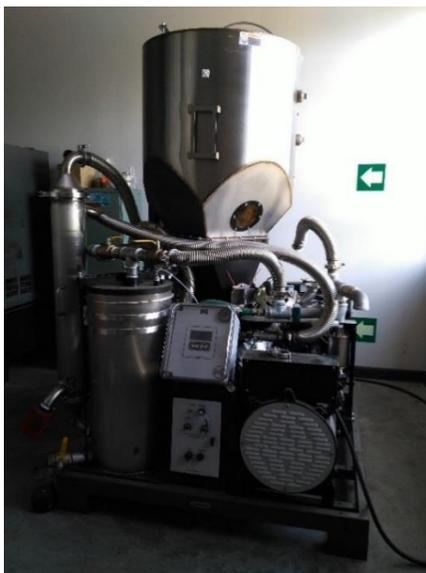
**Figura 5.1.** Unidad Power Palet de la empresa All Power Labs modelo PP20 (AllPowerLabs, 2015)
