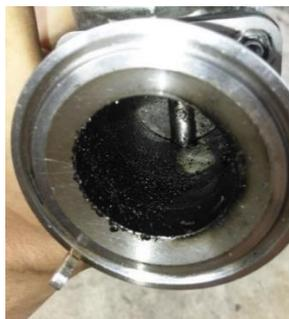
**Figura 6.18.** Ensuciamiento típico en el gobernador en una corrida con astillas de madera en planta piloto del ICAFE (Torres, 2016)
