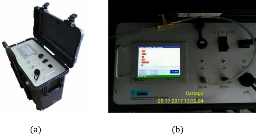
**Figura 5.15.** (a) Analizador MCA 100 Syn Portable MULTICOMPONENT ANALYZER FOR SynGAS (b) Instalación de línea de syngas limpio y seco al analizador
