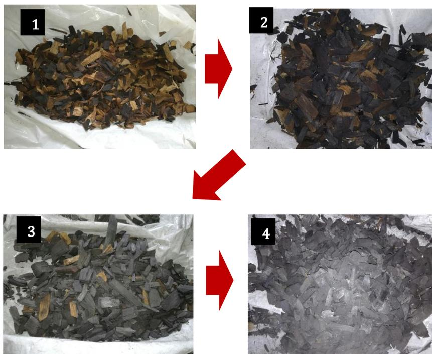
**Figura 6.22.** Visualización de la degradación térmica de las astillas de madera 1) Pirólisis baja 2) Pirólisis superior 3) Combustión 4) Reducción
