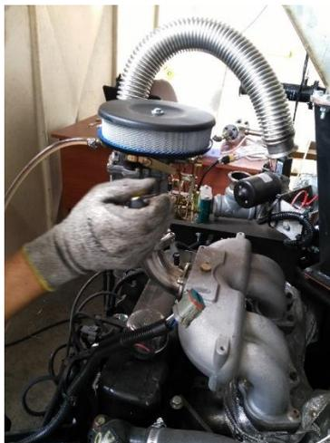
**Figura 6.3.** Instalación del carburador en el motor para efectuar la limpieza del motor
