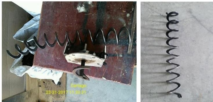
**Figura 6.15.** Fractura en el tornillo de alimentación de combustible al sistema Ante operación con pellets de madera
