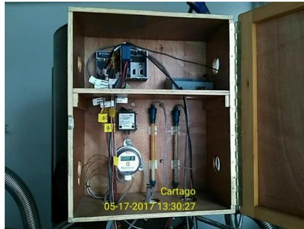
**Figura 5.13.** Instalación de unidad de adquisición de datos en la planta piloto
