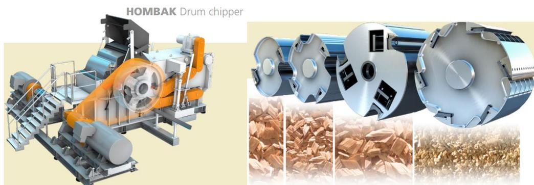
**Figura 3.3.** Esquema general de un triturador de madera de tambor (Carlton-Inc, 2015)
