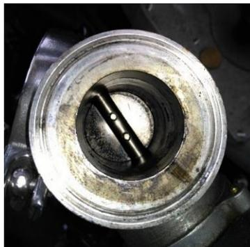
**Figura 6.21.** Condición de ensuciamiento del gobernador luego de 28 h motor
