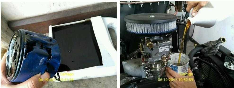
**Figura 6.2.** Estado del aceite del motor luego de 4 meses de adquirida la planta
