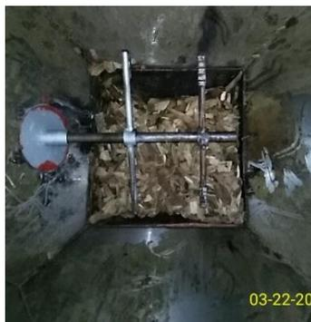
**Figura 5.20.** Sistema de agitación dentro de tolva de alimentación
