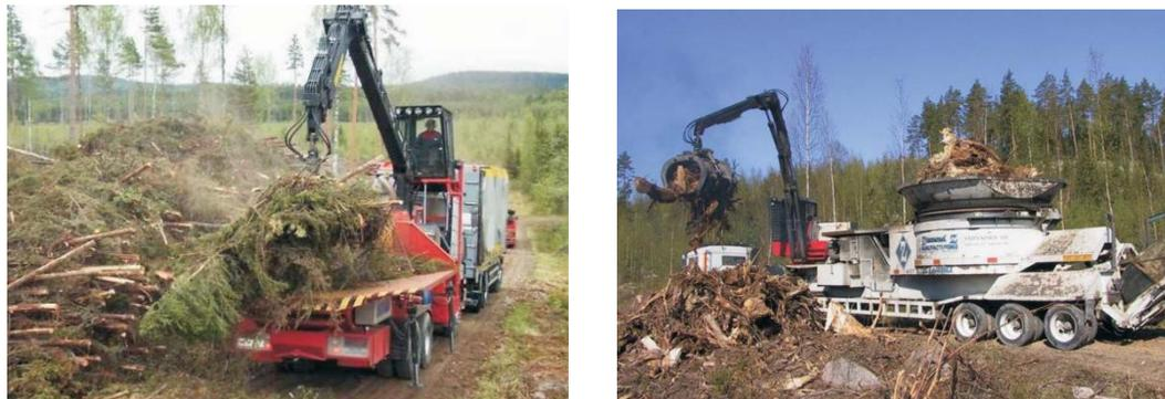
**Figura 3.5.** Ejemplos de maquinaria utilizada para triturar la madera en campo (ThomasNET, 2012)
