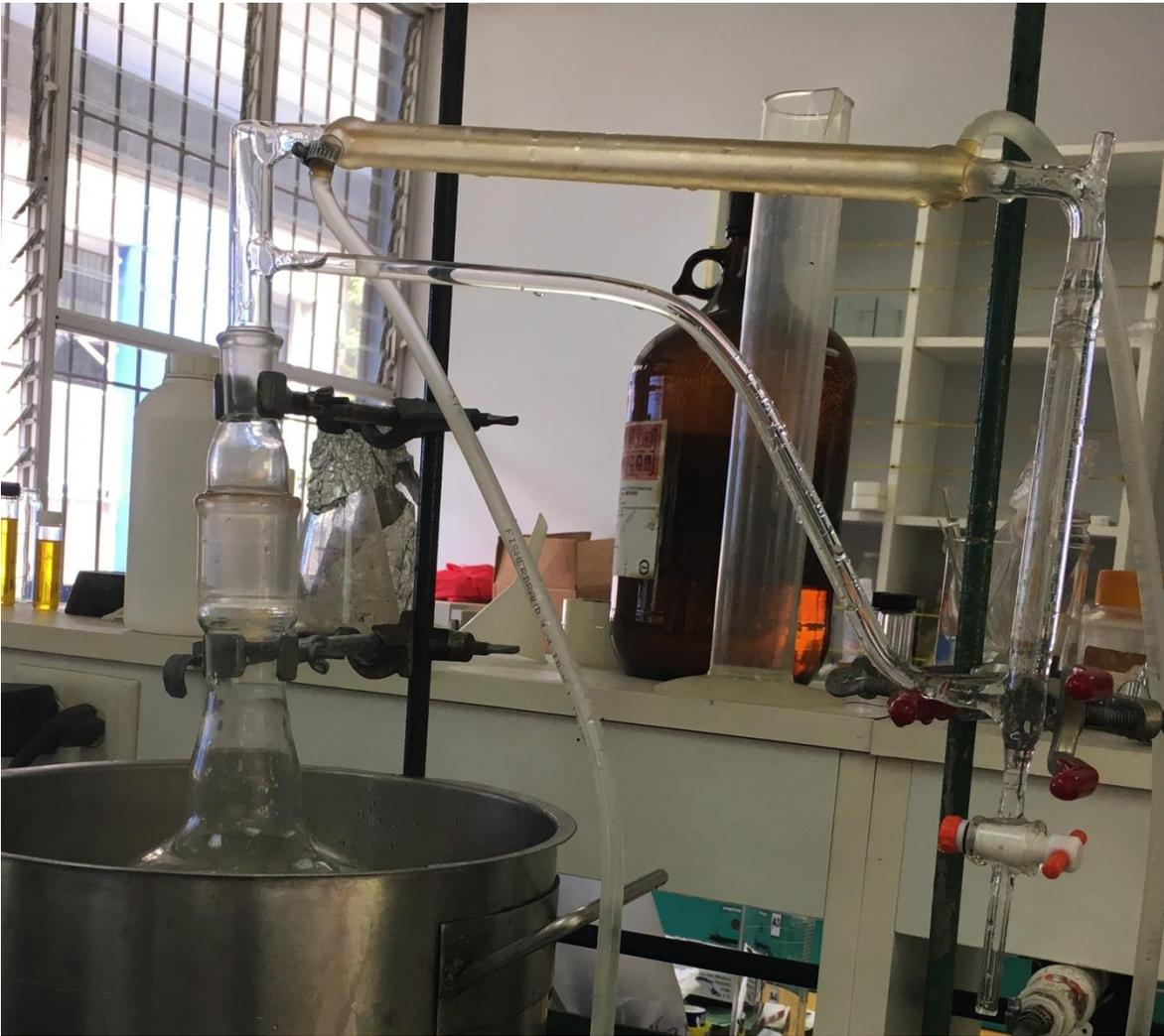
**Figura 10.** Equipo de destilación de arrastre por vapor de agua.
