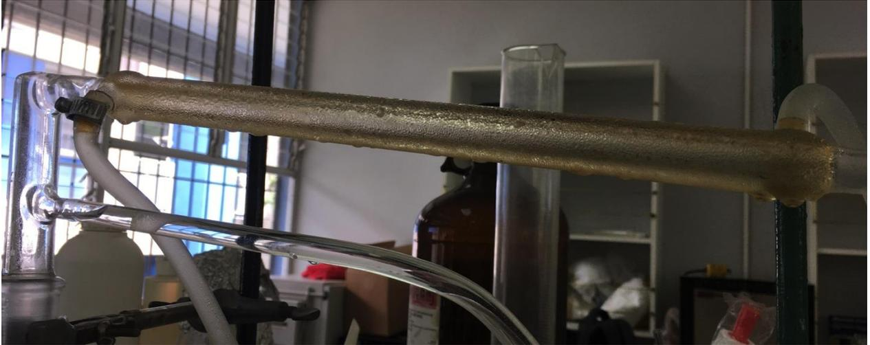
**Figura 11.** Condensador que permite el enfriamiento de la mezcla.
