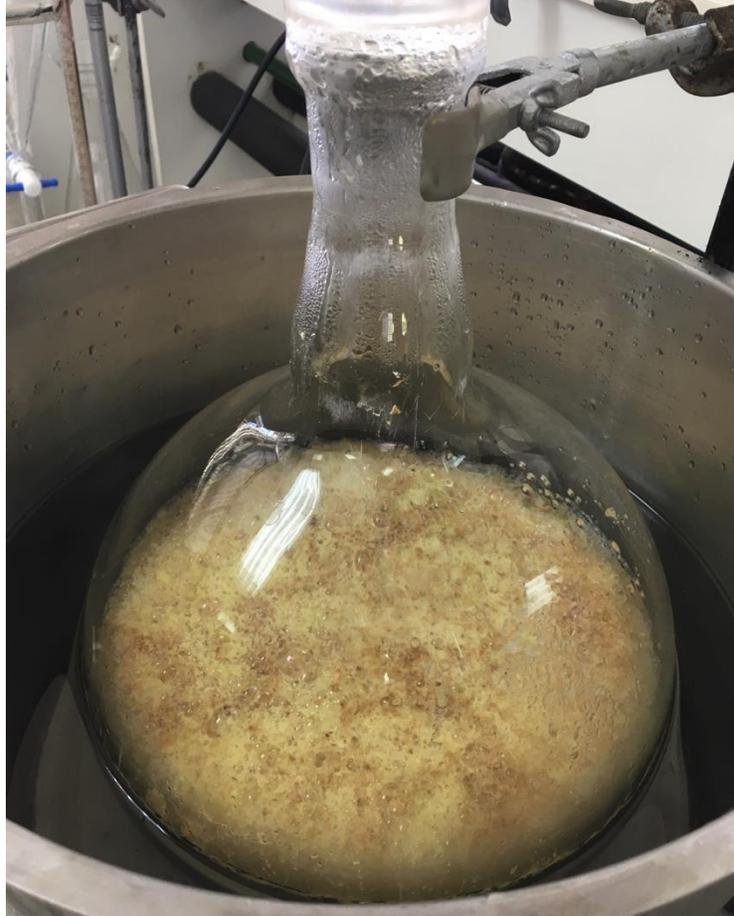
**Figura 5.** Licuado de 620 g de jengibre con 3 L de agua destilada en el balón colocado en el baño de glicerina, listo para iniciar el proceso de destilación.
