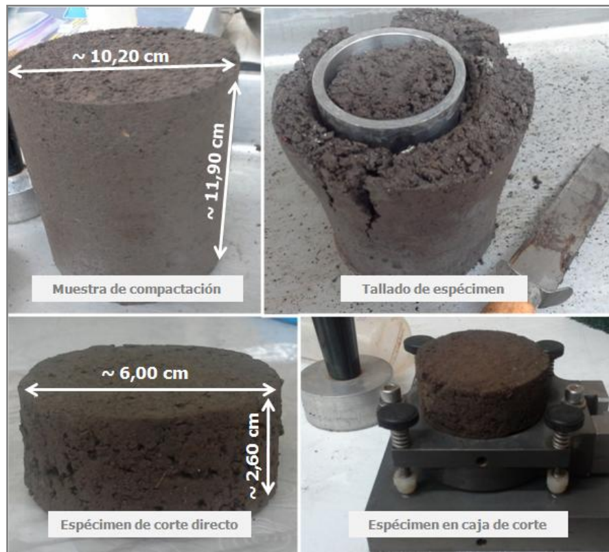
Figura 44. Elaboración de pastilla de corte directo
