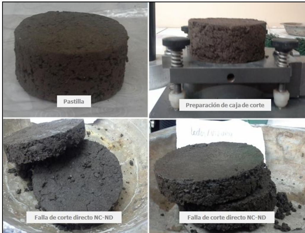
Figura 45. Falla de pastilla corte directo no consolidado-no drenado
