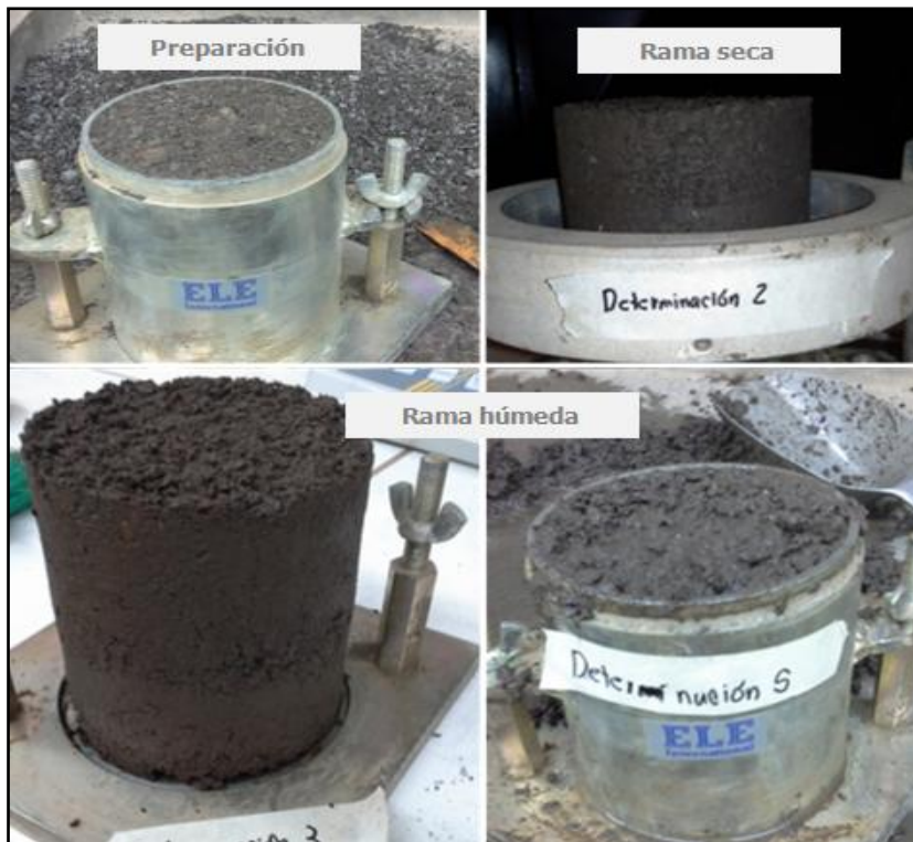
Figura 41. Compactación de muestra S-13
