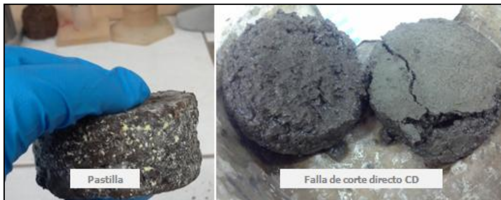
Figura 50. Falla de pastilla corte directo tipo consolidado-drenado
