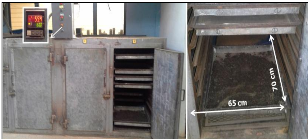
Figura 23. Condiciones de secado al horno en laboratorio
