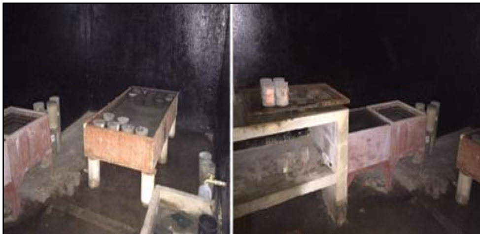
Figura 18. Almacenamiento de lodos antes de secado al horno
