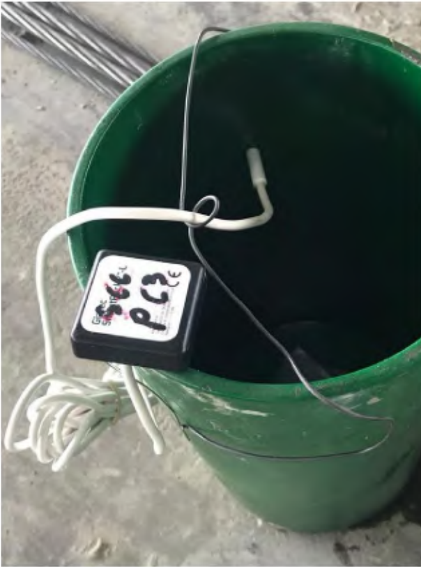
Figura 8.15. Colocación de dispositivo de madurez en cilindro 150mm antes de chorea.
