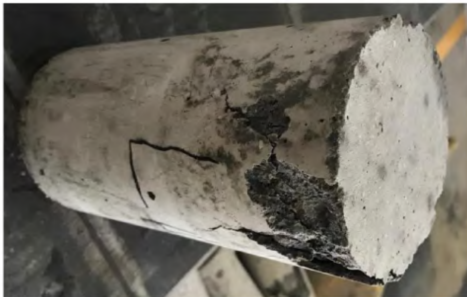
Figura 8.12 Foto de falla defectuosa a 14 días AC-CL011.
