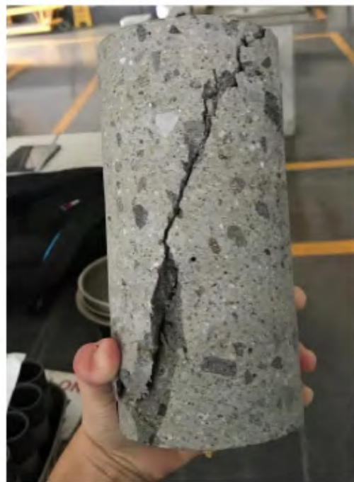
Figura 8.30. Tipo de falla de núcleo.
