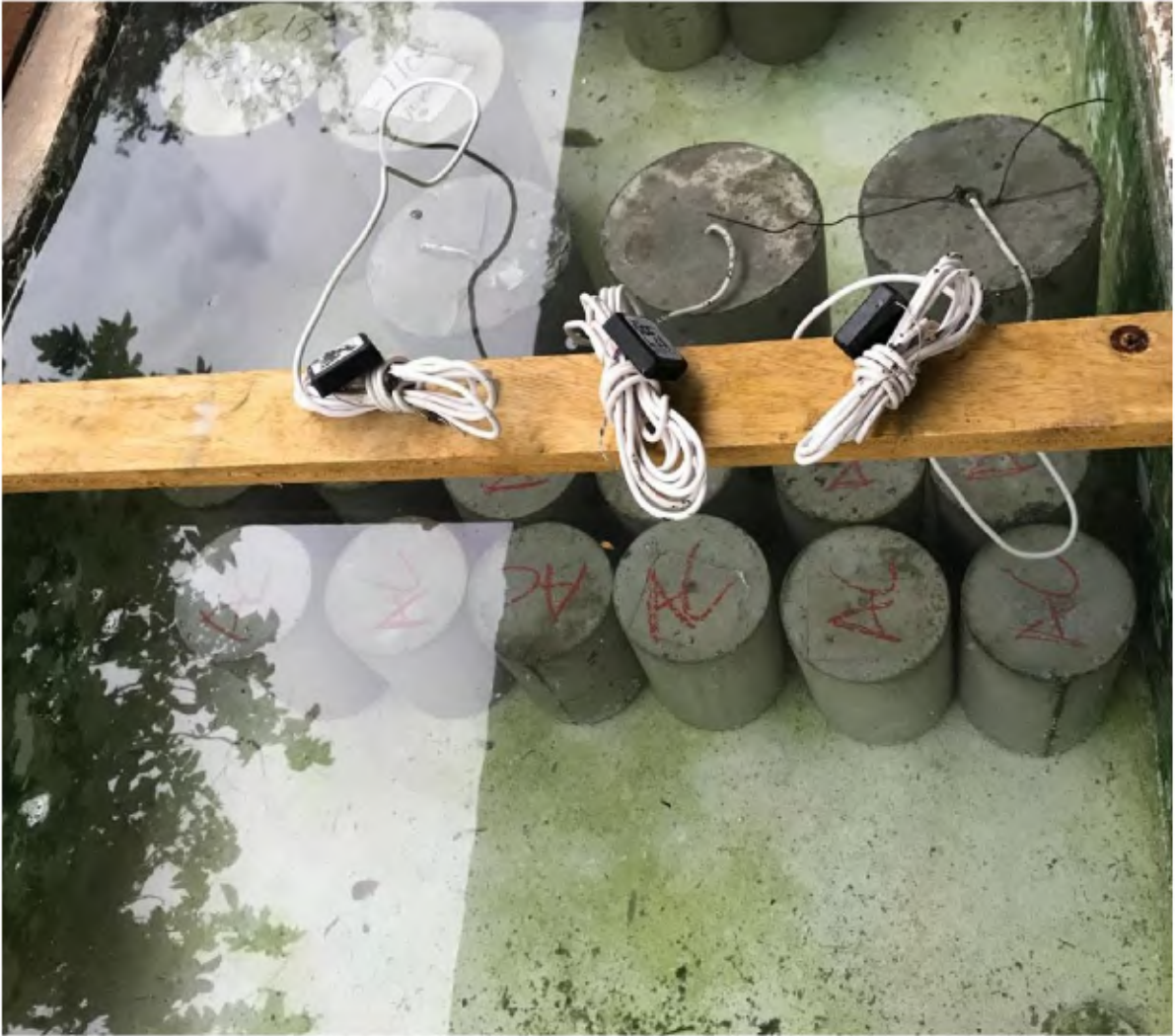
Figura 8.23. Cilindros curados en laboratorio sumergidos en agua.
