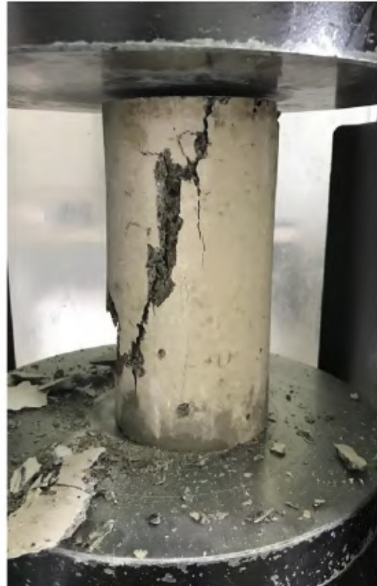
Figura 8.25. Falla de cilindros.
