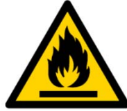
Figura 7.6. Señal a colocar sobre el área de almacenamiento de disolventes en estibas.
