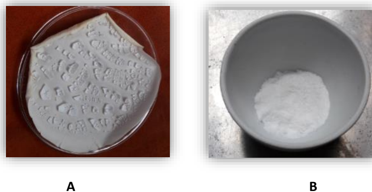
Figura 7. 2 A) Material después del proceso de secado, B) Material calcinado.
