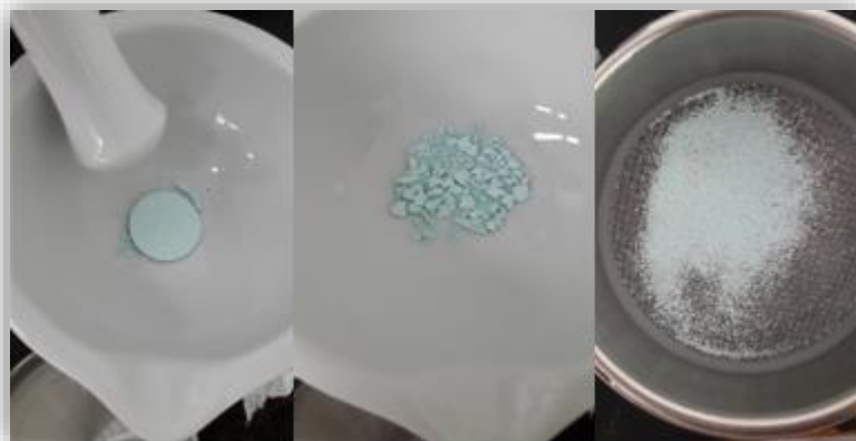
Figura 7. 5 Tableta, quebrado y tamizado del catalizador.
