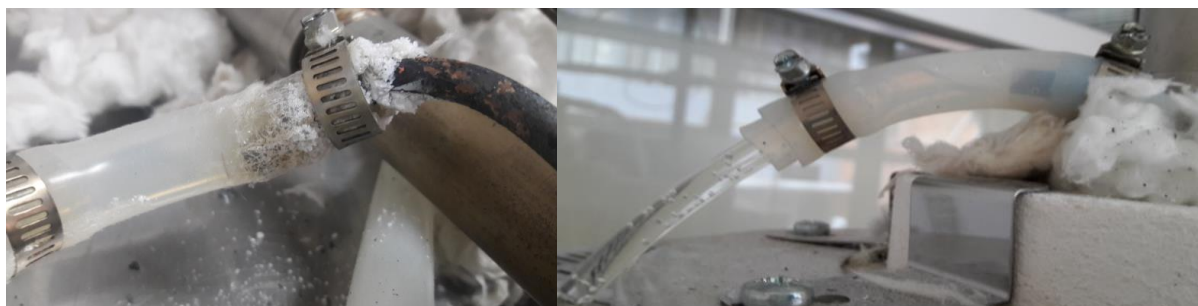
Figura 8. 23 Manguera utilizada para la alimentación del etanol al serpentín empleado para su evaporación.
