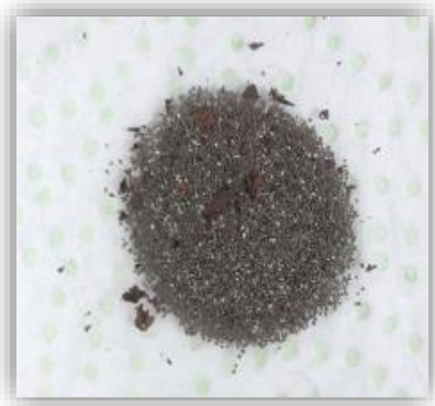
Figura 8. 21 Catalizador recuperado después de la reacción.
