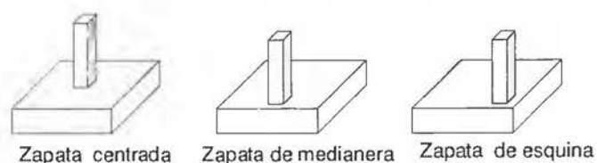
Figura 11. Ubicación de columna en placa aislada
