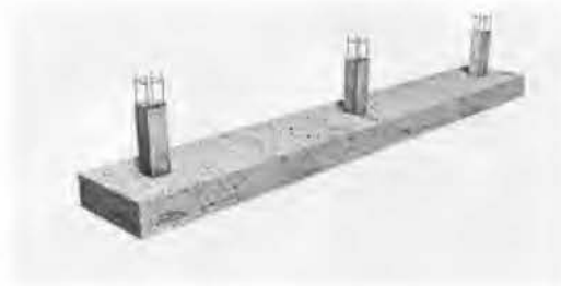
Figura 13. Placa corrida bajo columnas
