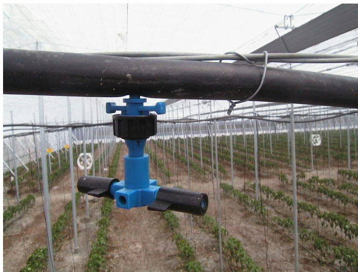
Figura 2.13: Boquilla utilizada en invernaderos para enfriamiento evaporativo por nebulización (Cervantes, 2015)
