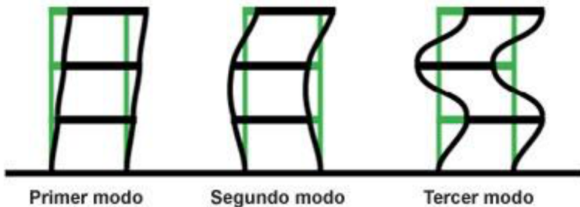
Figura 10. Modos de vibración de un edificio.
