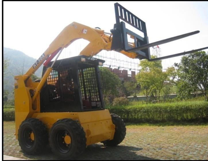
Figura 8. Montacargas tipo Bobcat
