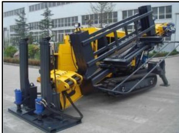
Figura 14. Perforadora Horizontal Direccional FDP-32
