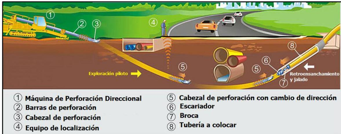
Figura 18. Partes de la máquina
