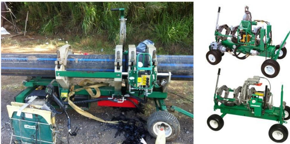
Figura 9. Máquina de Termofusión TracStar™ 28
