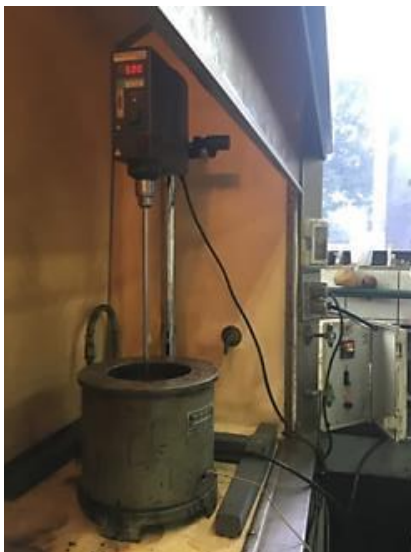
Figura 5. 8 Equipo para modificar asfalto: recipiente de mezclado, agitador y controlador de temperatura (Propio, 2017).
