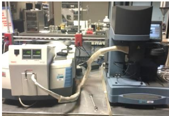
Figura 5. 7 Equipo de prueba termogravimétrica acoplada a espectroscopía infrarroja de transformada de Fourier (Propio, 2017).
