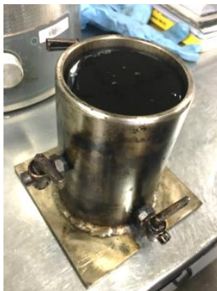
Figura 5. 11 Columna de estabilidad (Propio, 2017).
