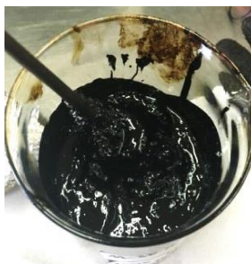
Figura 6. 5 Muestra de asfalto modificado con plástico de envases de agroquímicos al 1,5 % que presenta mala incorporación del polímero a la matriz asfáltica (Propio, 2016).
