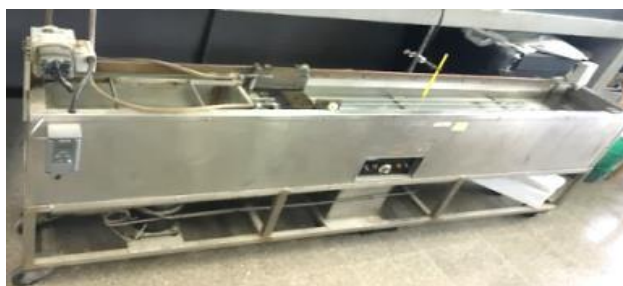
Figura 5. 3 Baño para la determinación de la recuperación elástica (Propio, 2017).
