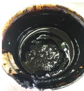
Figura 6. 6 Muestra de asfalto modificado con plástico de envases de agroquímicos al 1,1 % que presenta mala incorporación del polímero a la matriz asfáltica (Propio, 2016).
