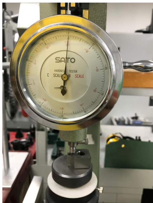
Figura 4.6.1 Medición de dureza cara interna de parte de troquelado.
