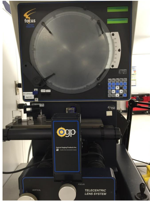
Figura 3.7.7 Comparador Óptico para revisión de geometría del alambre
