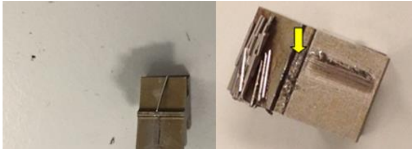
Figura 4.1.6 Adherencia en las partes de troquelado en un evento de producción.
