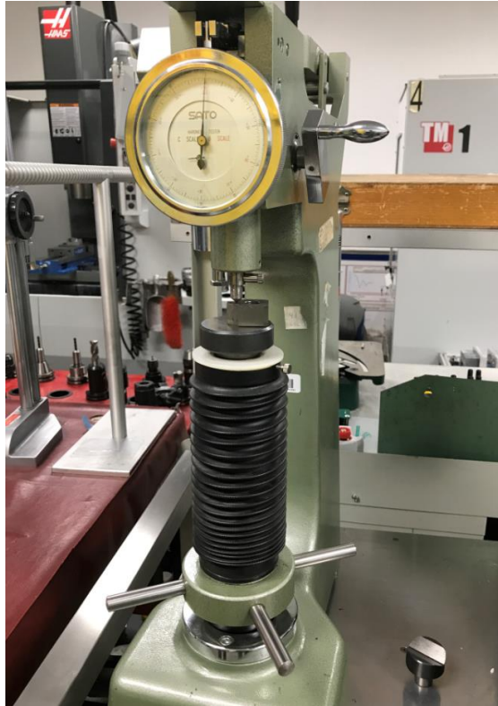
Figura 3.7.5 Durómetro utilizado para comparación en Rc.
