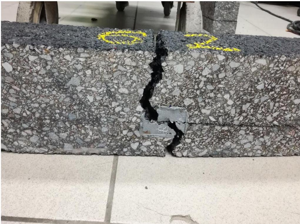
*Figura 3.13. Viga G2 luego de ser ensayada*
