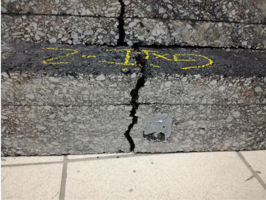
*Figura 3.16. Viga GxII-2 luego de ser ensayada*
