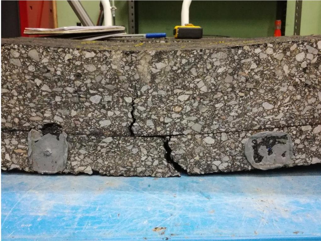
*Figura 3.10. Viga GxI-2 luego de ser ensayada*
