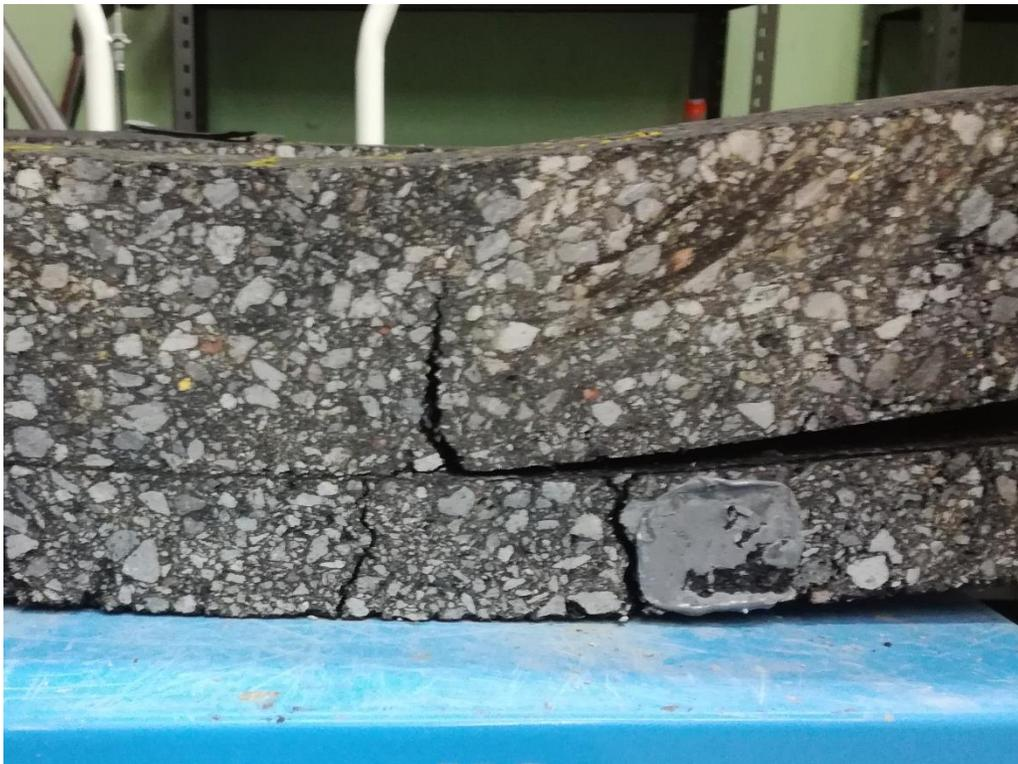
*Figura 3.9. Viga Gx1-1 luego de ser ensayada*
