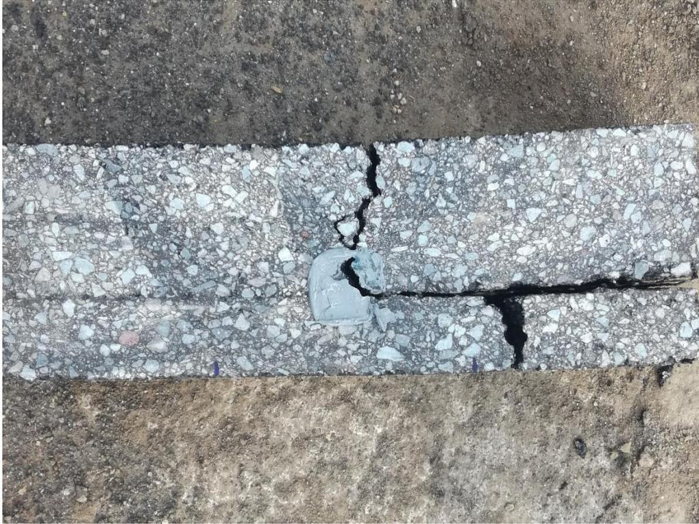
*Figura 3.12. Viga G1 luego de ser ensayada*
