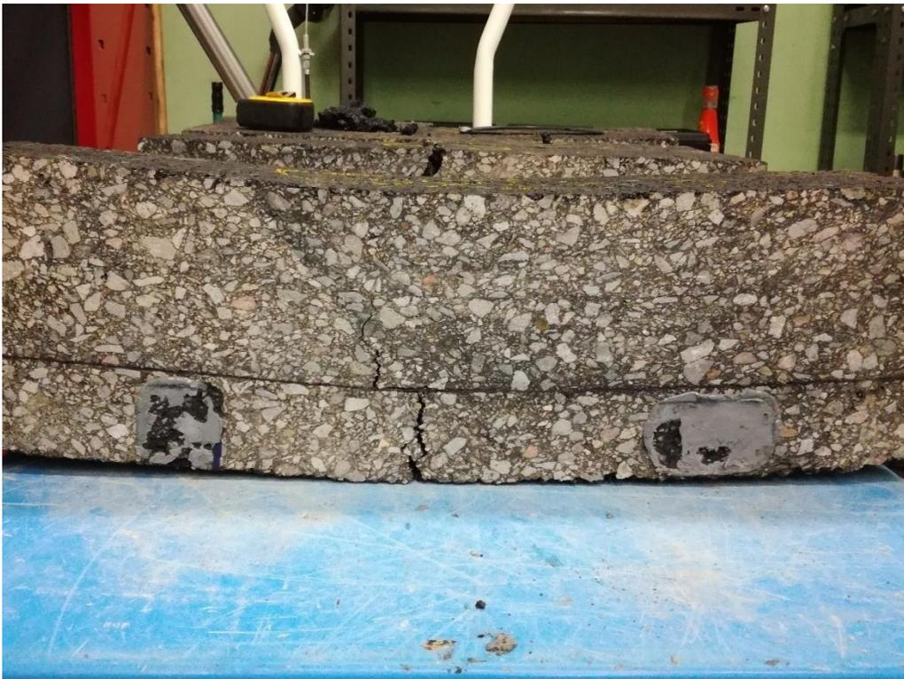
*Figura 3.11. Viga GxI-3 luego de ser ensayada*
