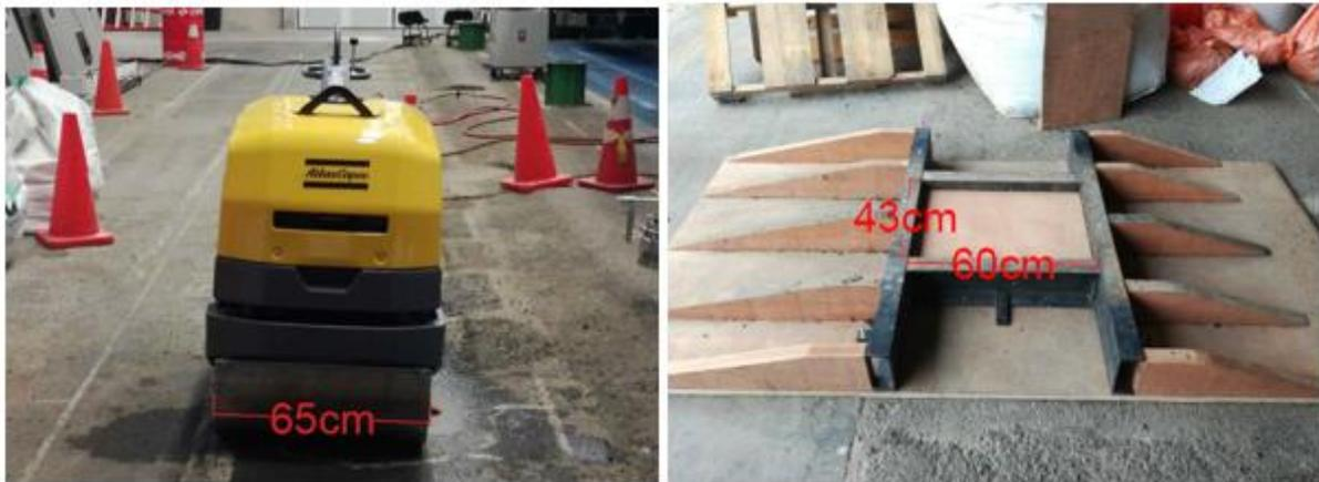
*Figura 3.1. Dimensiones del rodillo compactador y del molde a escala elaborado en el LanammeUCR*
