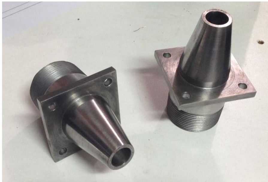
Figura 4.12: Inyectores en acero 1020 comercial. Fuente: Autores.
