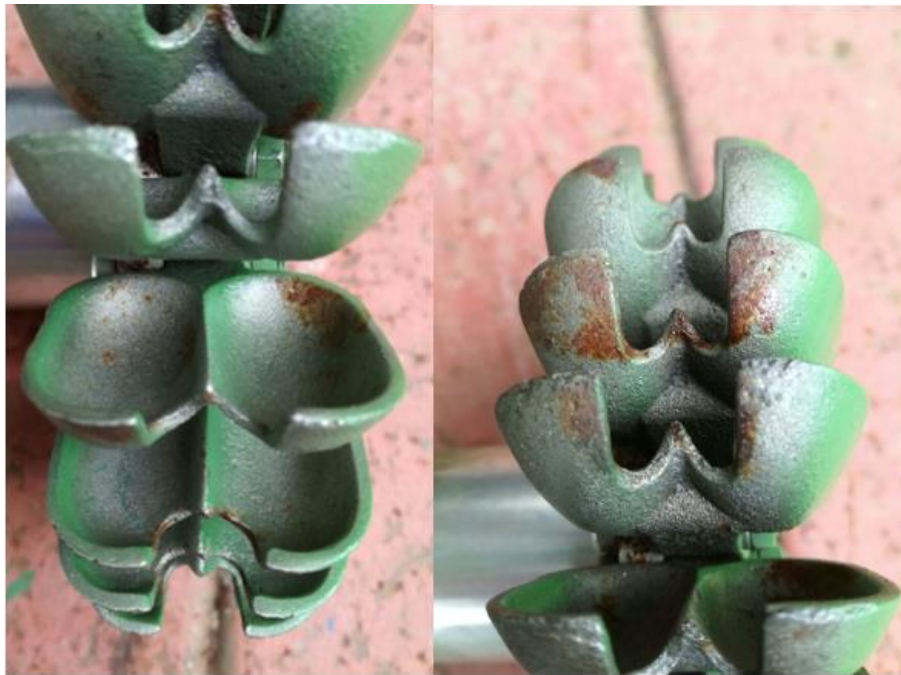
Figura 5.16: Corrosión superficial puntualizada sobre los álabes fundidos posterior a las pruebas realizadas. Fuente: Autores.
