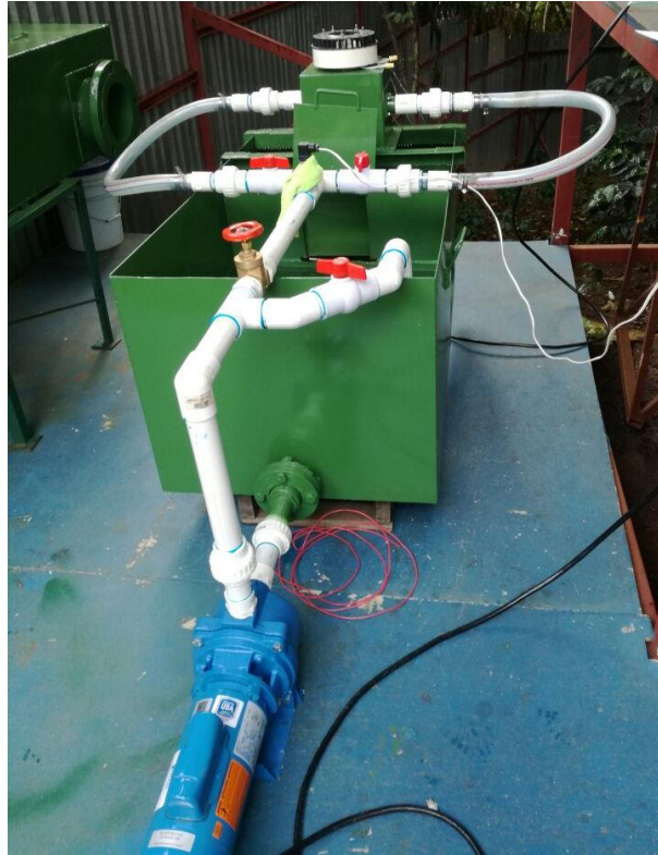
Figura 5.10: Banco de pruebas utilizado para verificar funcionamiento de la turbina. Fuente: Autores.
