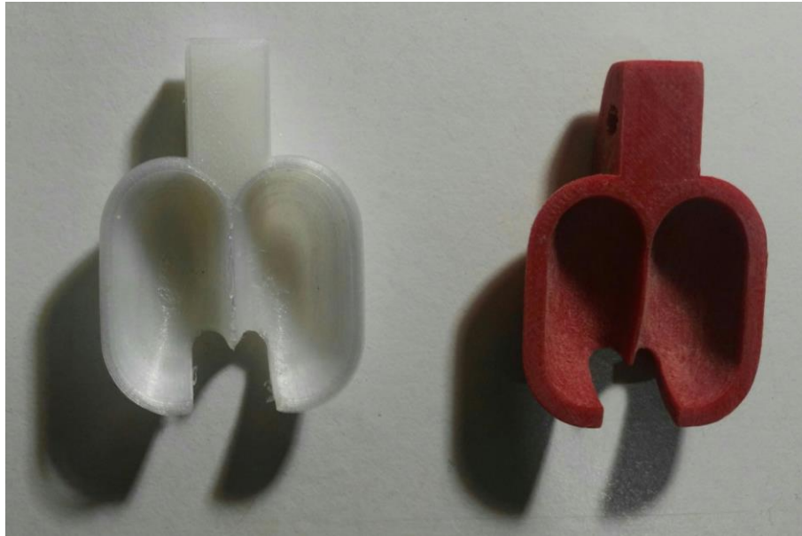
Figura 4.7: Impresiones 3D del álabe en nylon y ABS respectivamente. Fuente: Autores.
