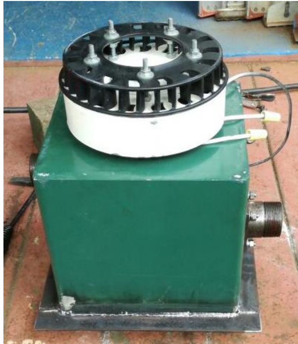
Figura 4.18: Ensamble final de la turbina. Fuente: Autores
