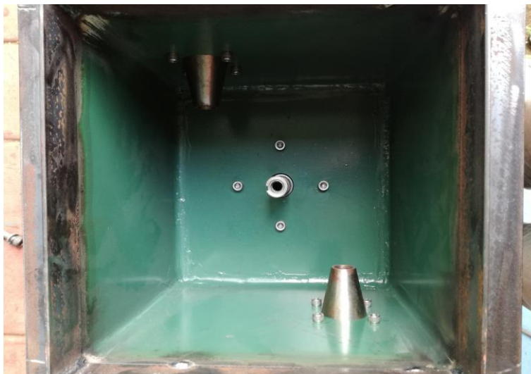
Figura 4.16: Tornillos de montura del generador. Fuente: Autores.
