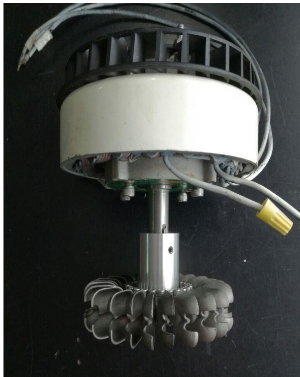
Figura 4.15: Acople del rodete al eje del generador. Fuente: Autores
