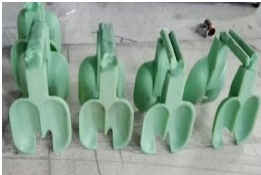
Figura 4.8: Moldes de cera perdida. Fuente: Autores
