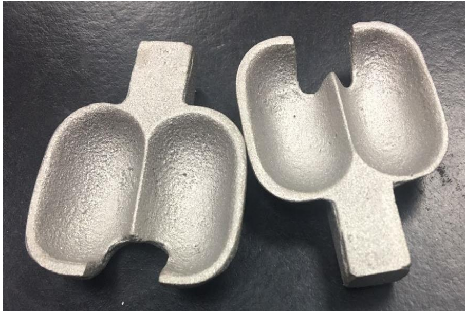
Figura 4.9: Álabes fundidos en acero inoxidable 420. Fuente: Autores.
