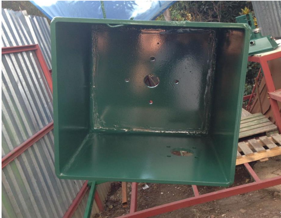
Figura 4.13. Acabado final del interior de la carcasa. Fuente: Autores.
