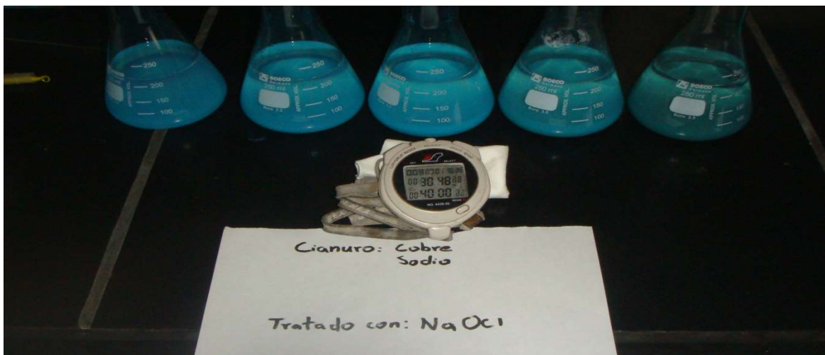
Figura 3.1. Pruebas para tratamiento de cianuro de cobre y sodio, mediante hipoclorito de sodio.
