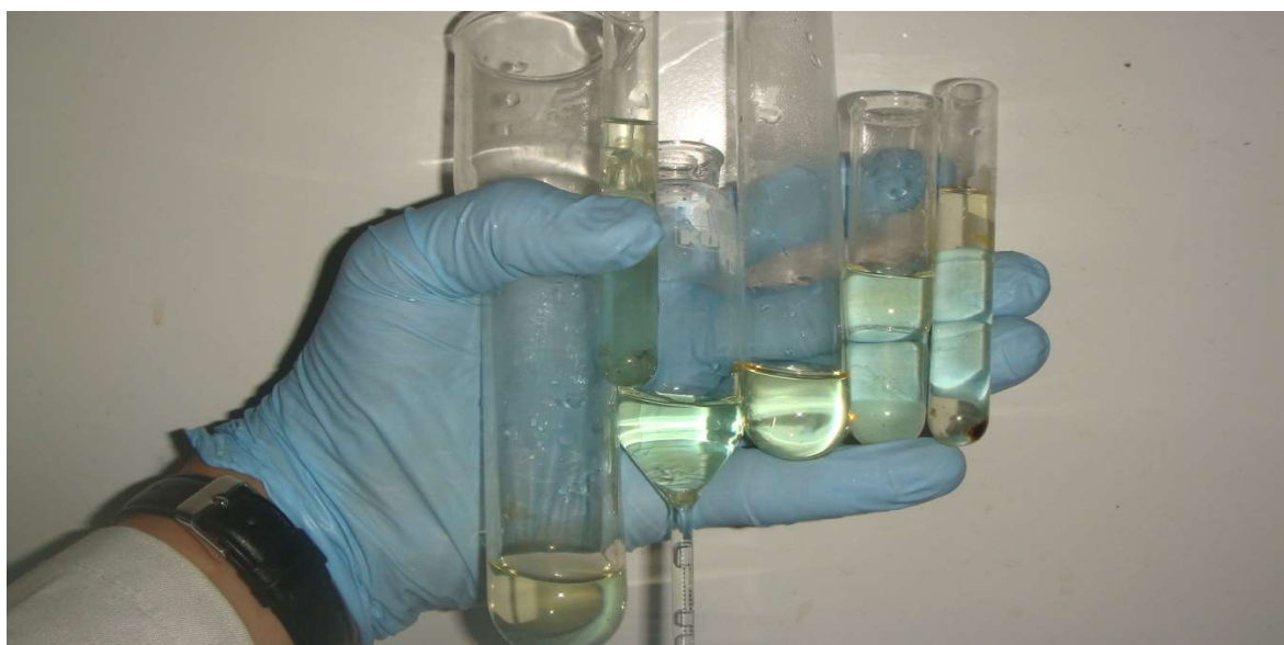
Figura 3.5. Resultados visuales para las pruebas positivas de degradación de cianuro de oro-potasio, mediante hipoclorito de sodio.
