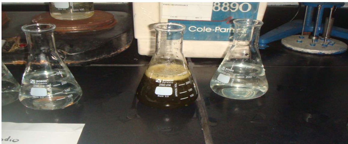
Figura 3.15. Adición de peróxido de hidrógeno e hipoclorito de sodio al cianuro de cobre y sodio con cianuro de oro potasio.
