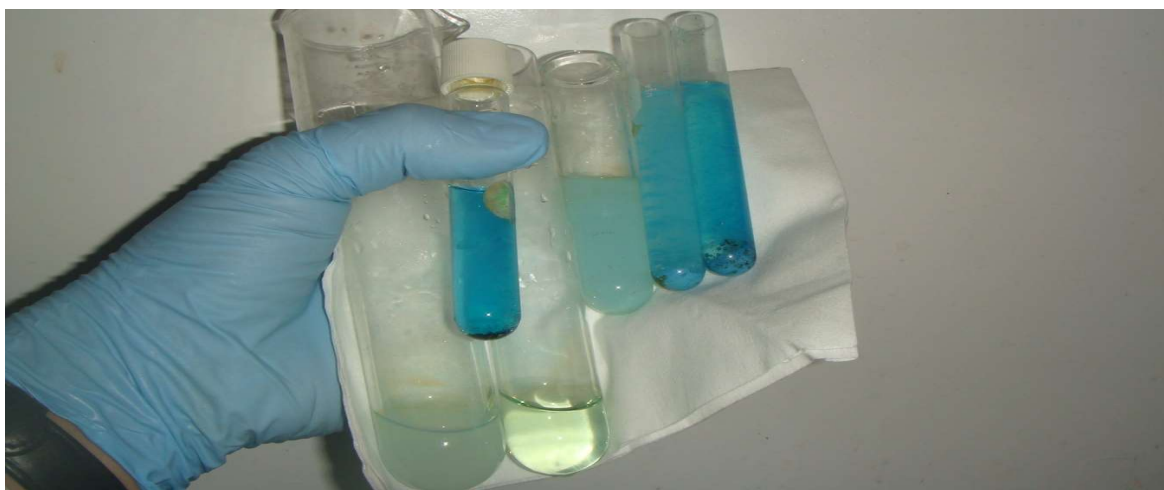
Figura 3.11. Pruebas para determinación de presencia de cianuro cobre y sodio.
