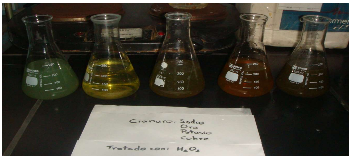
Figura 3.10. Mezcla de cianuros tratada con peróxido de hidrógeno.
