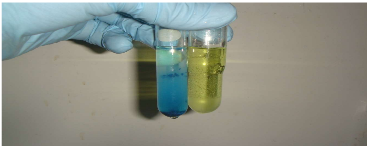
Figura 3.2. Pruebas cualitativas para demostrar presencia de cianuro en disolución. A la izquierda, prueba negativa, demostrando presencia de cianuro, a la derecha, prueba positiva, eliminación del cianuro en disolución.
