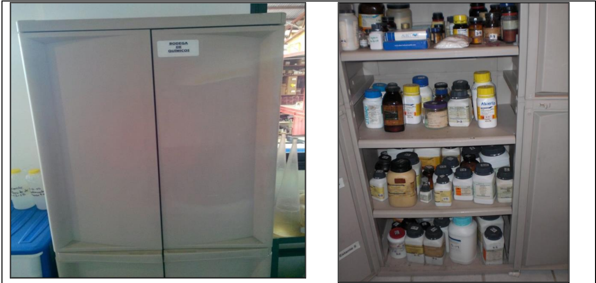
Figura 6. Bodega de reactivos químicos, donde se separan de acuerdo a su reactividad
