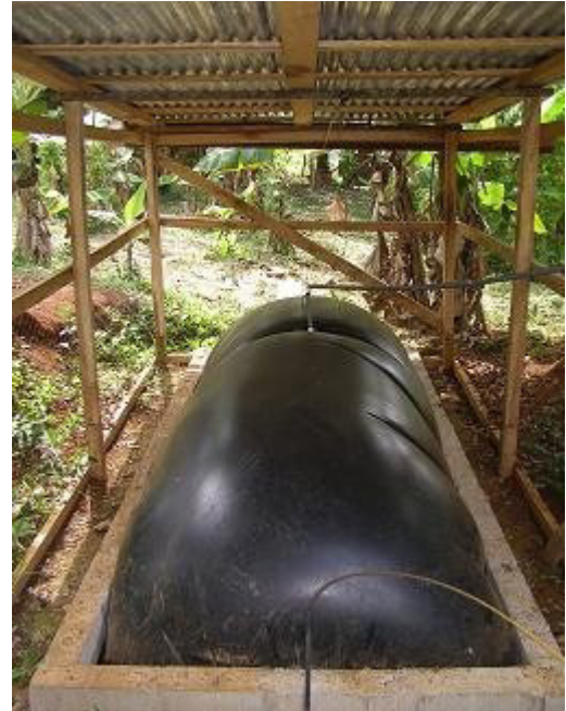
Foto 30: Biodigestor de tipo flujo continuo y estructura flexible
