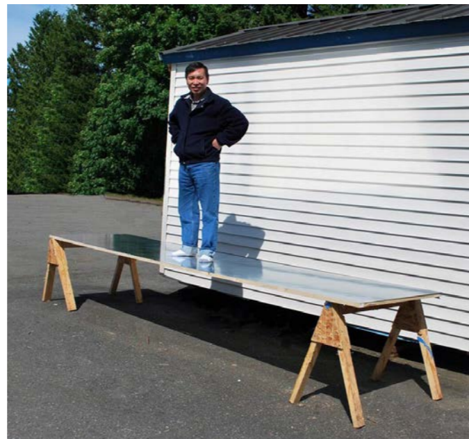
▼ Imagen N° 81. Panel con piel de aluminio que le permite luces largas, con espesores y pesos mínimos. Fuente: SingCore, 2017b
