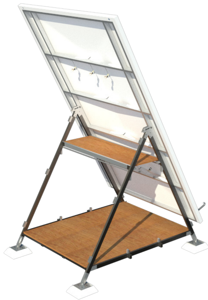
▼ Imagen N° 85. Colocación temporal durante el ensamble de la Estructura de Cubierta en la Estructura Principal del MAD. Autoría propia.
