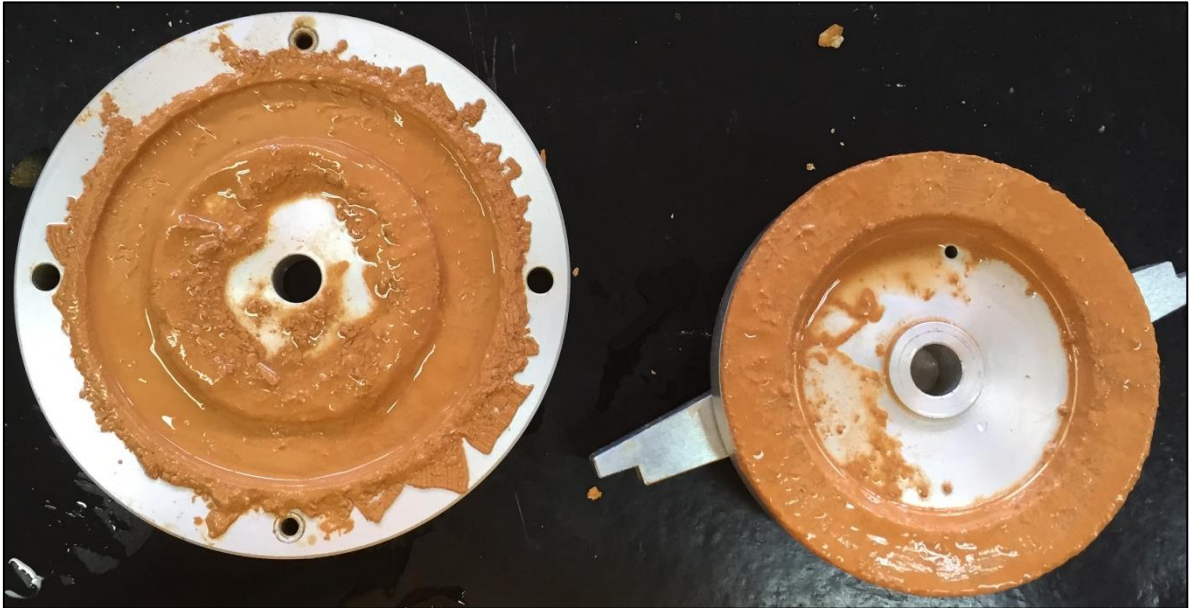
Figura 85. Superficie de falla típica al final de los ensayos del suelo 1 (Torshear)
