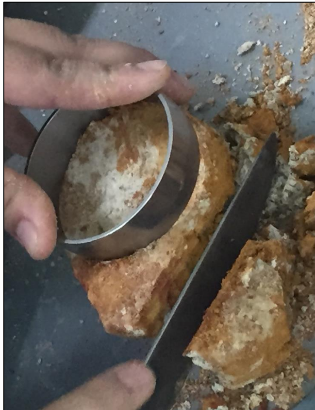
Figura 49. Preparación de la muestra de suelo inalterada para la prueba en el equipo Shearmatic
