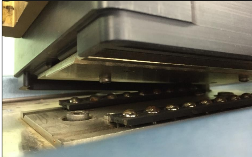
Figura 125. Rieles y tiras de balines bajo la caja de corte de la máquina Shearmatic
