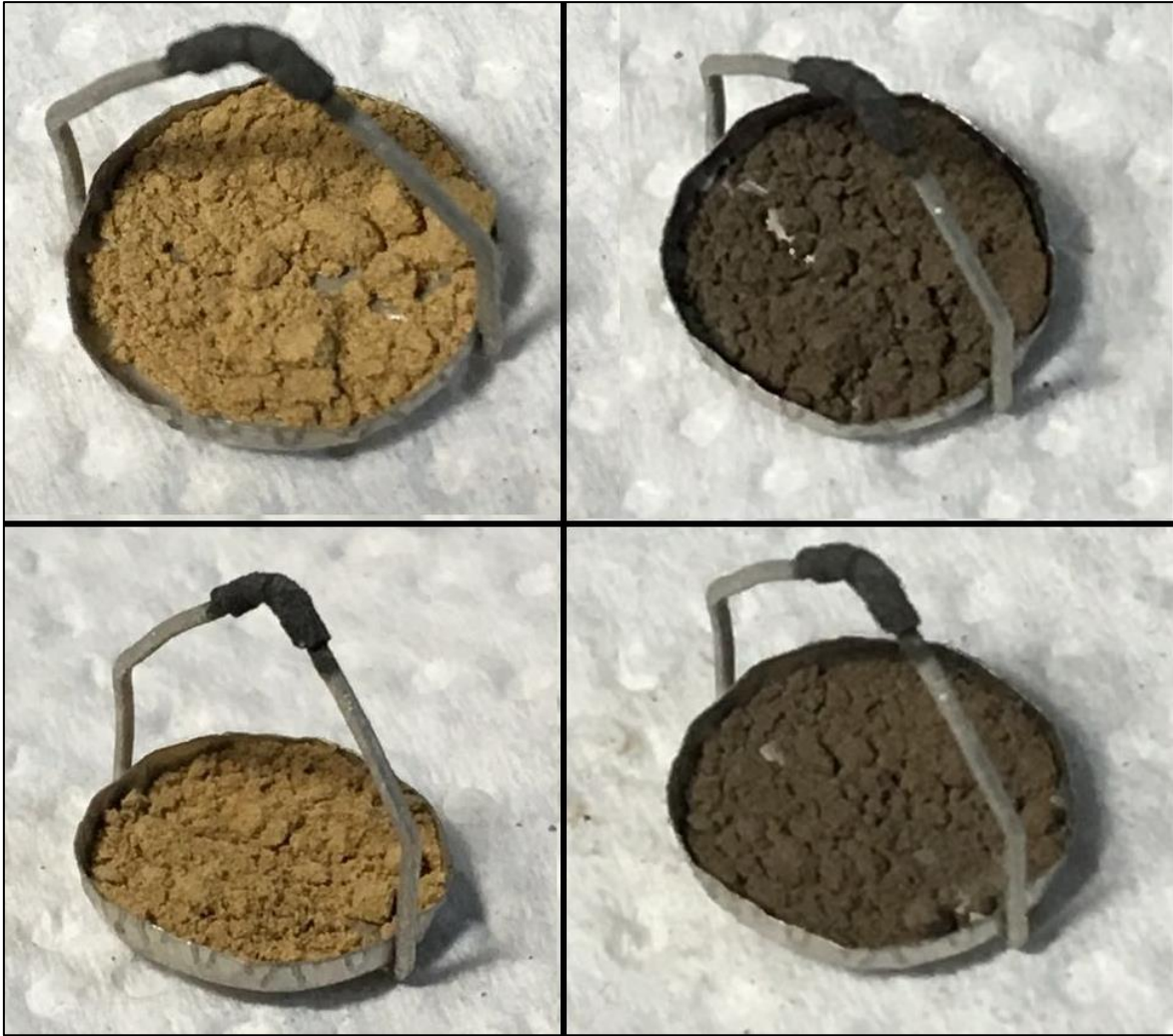
Figura 39. Muestras de suelo 2 antes y después del ensayo de TGA
