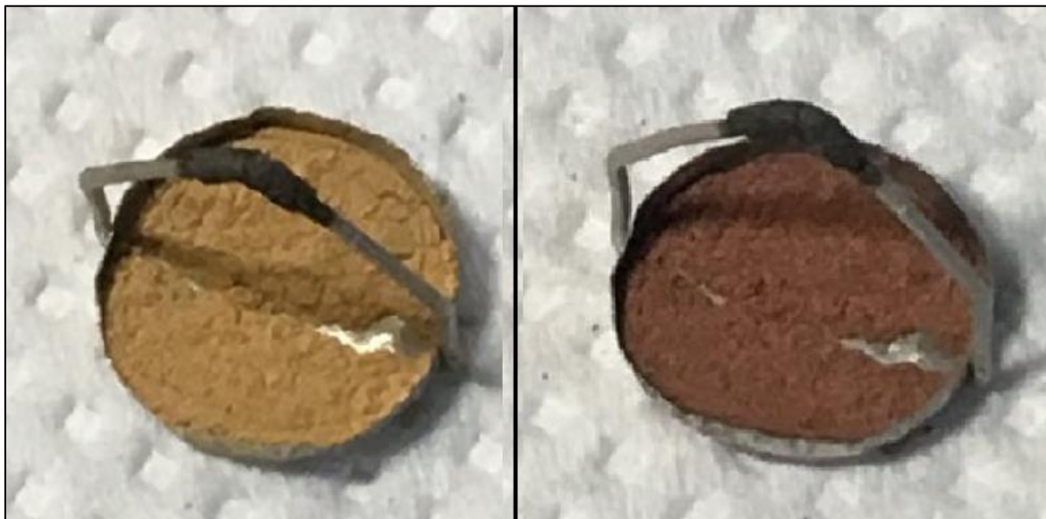
Figura 26. Muestra de suelo 1 antes y después del ensayo de TGA
