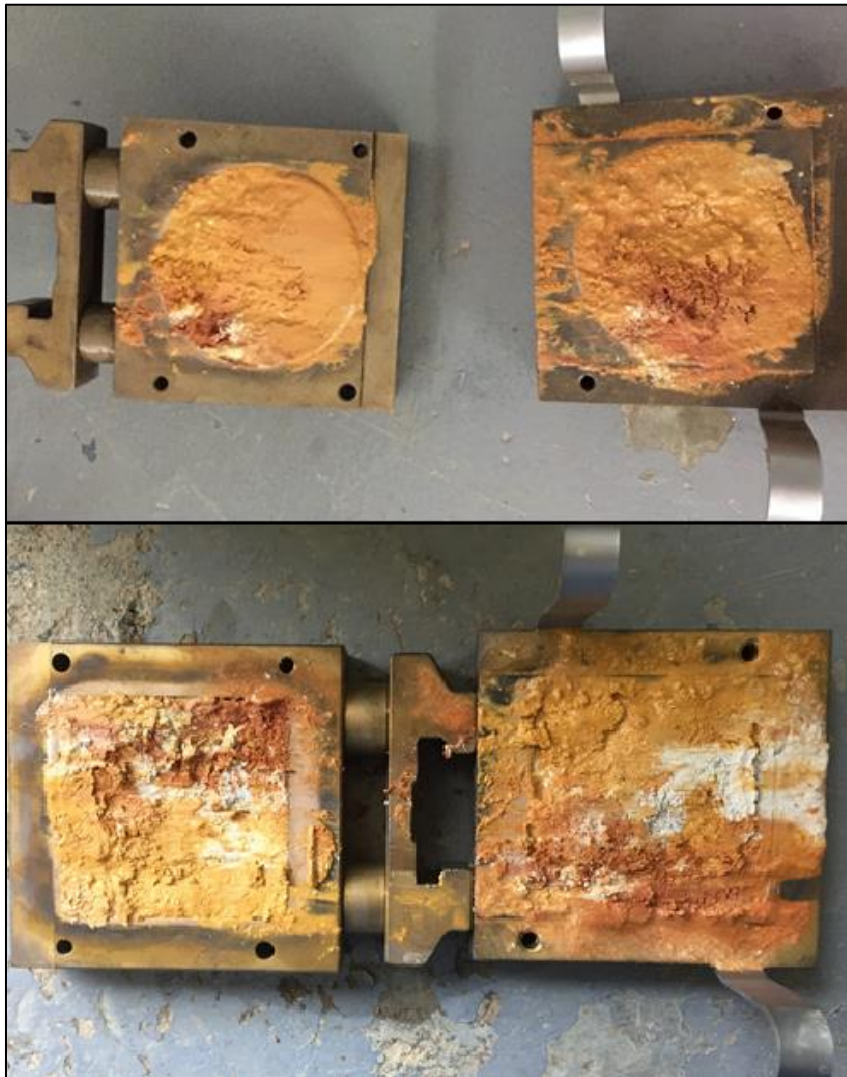
Figura 55. Superficie de falla típica al final de los ensayos del suelo 1 (Shearmatic)
