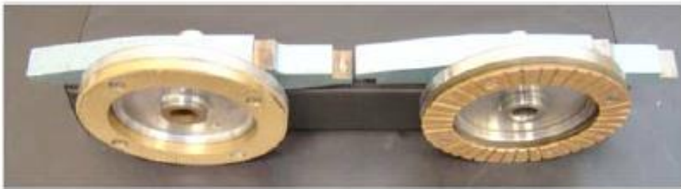
Figura 15. Diferencia entre la placa original y la modificada para el aparato de Bromhead. Fuente: Meehan et al. 2007
