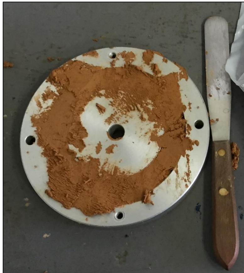
Figura 52. Preparación de la muestra para el equipo Torshear 1
