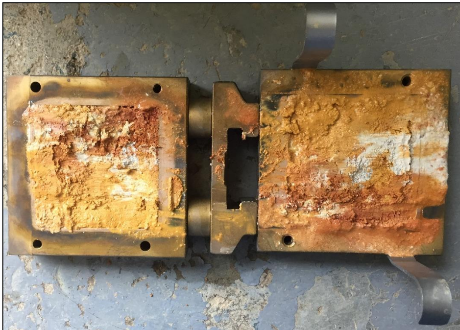
Figura 50. Superficie de falla de un ensayo en el equipo Shearmatic
