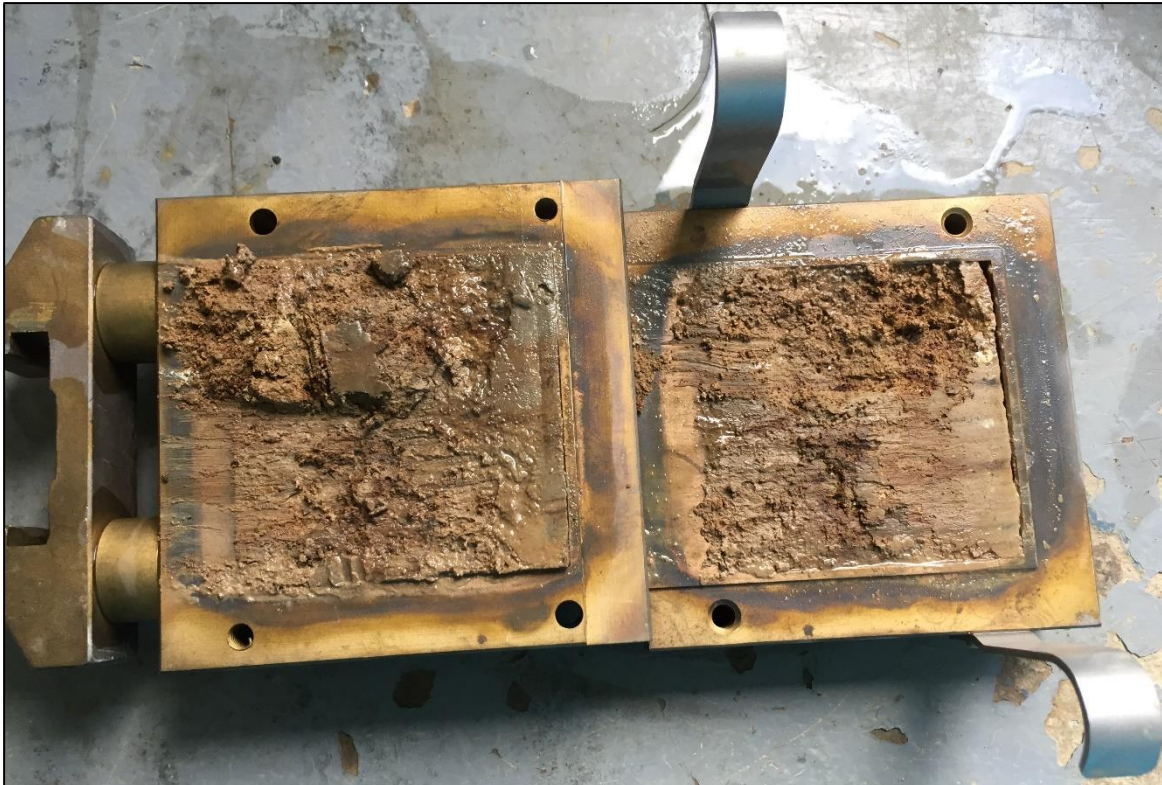
Figura 86. Superficie de falla típica al final de los ensayos del suelo 2 (Shearmatic)
