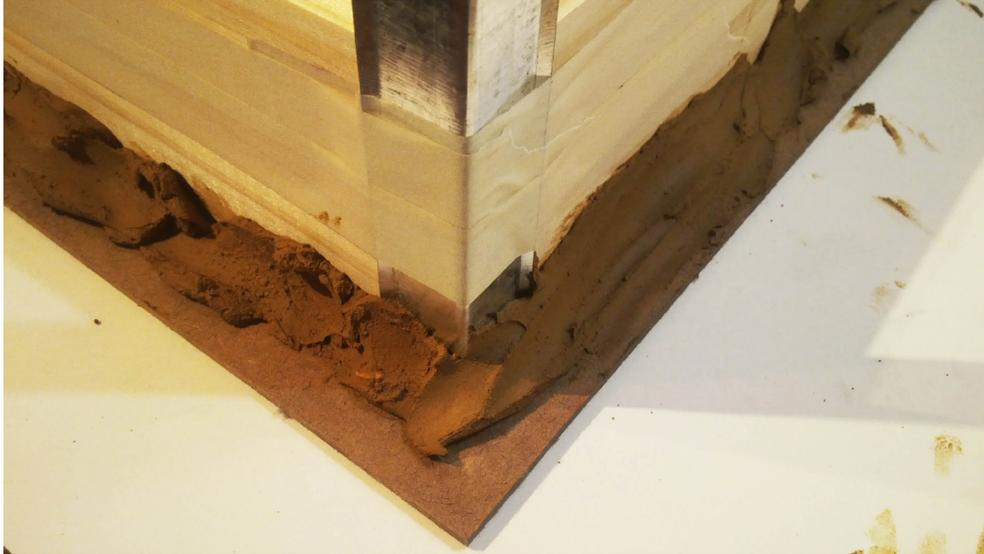
**Imagen 53.** Se sellan las esquinas con arcilla para evitar fugas
