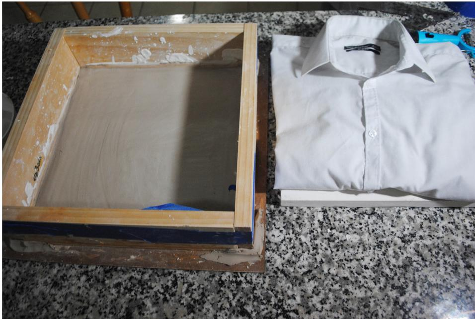
**Imagen 54.** Molde para la pieza superior de las camisas en yeso y referencia.
