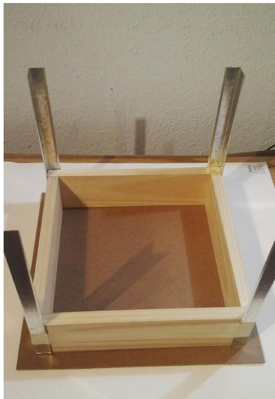
**Imagen 52.** Preparación del molde para el yeso
