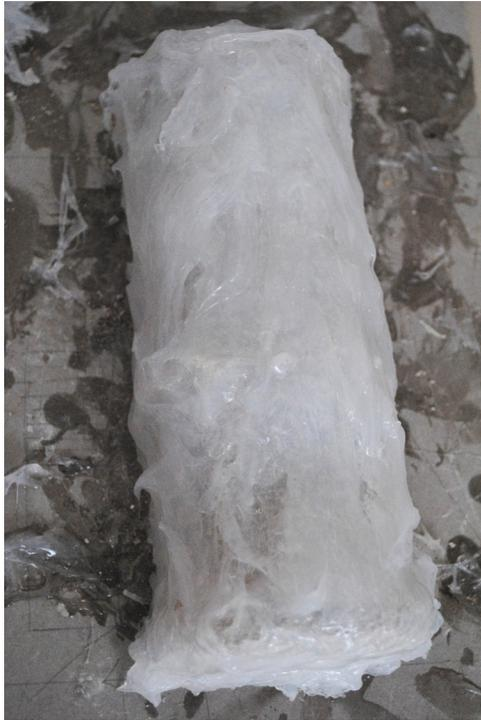
**Imagen 82.** Molde terminado de silicón
