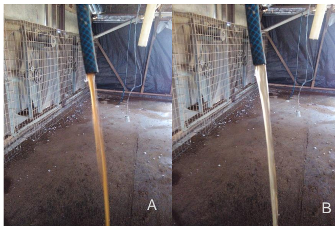
Figura 3. Fotografías de la salida del agua al iniciar el flushing (A) y al finalizar el drenaje (B) de la galera #2 granja B.
