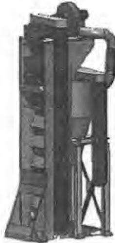
Figura 5.10. Diagrama de elutriador.
