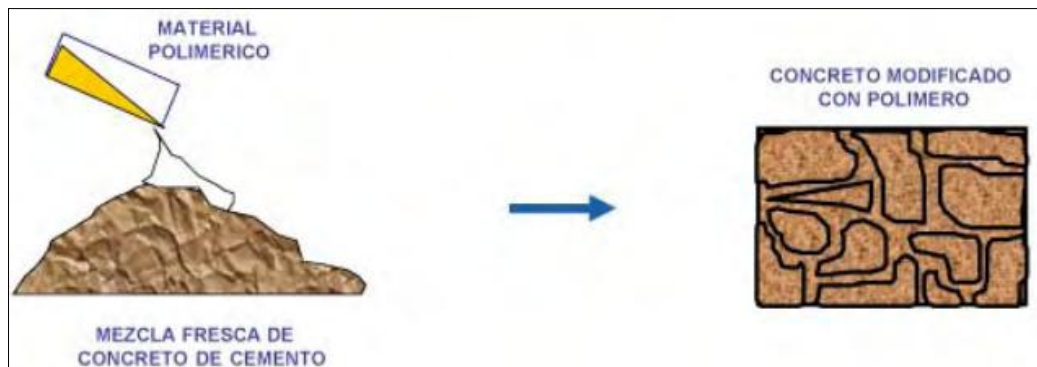
Figura 2.24. Fabricación de concreto modificado con polímeros
