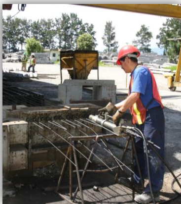
Figura 2.28. El uso de concreto de fraguado acelerado en un elemento pos tensionado para la fabricación en serie de los mismos Tomado de: Industrial Escosa S.A., s.f.
