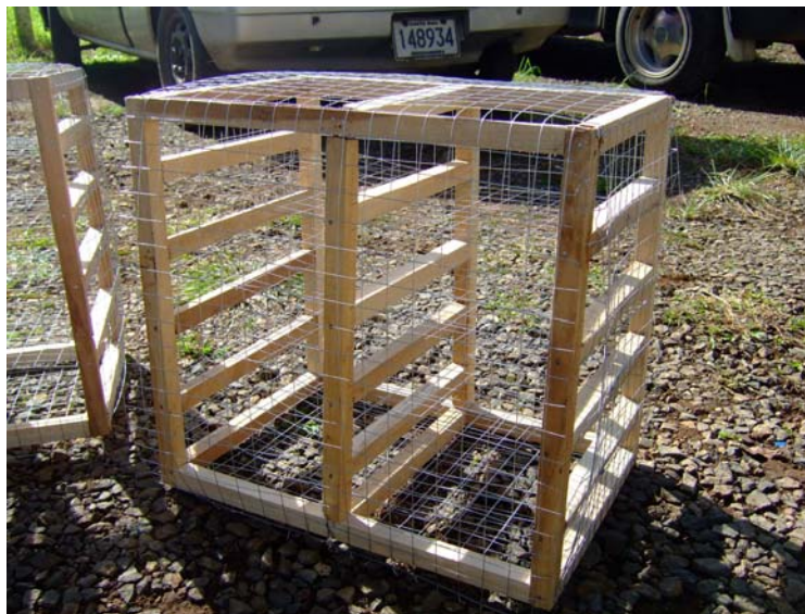
Figura 3.1 Caja utilizada para enterrar las muestras plásticas en los rellenos sanitarios
