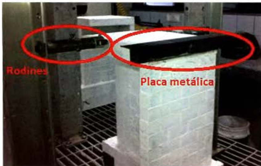
Figura 36. Restricción lateral y placa metálica para distribución de la carga.
