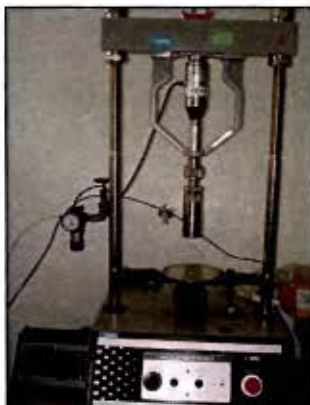
Figura 5. Máquina universal para la falla de los bloques.
