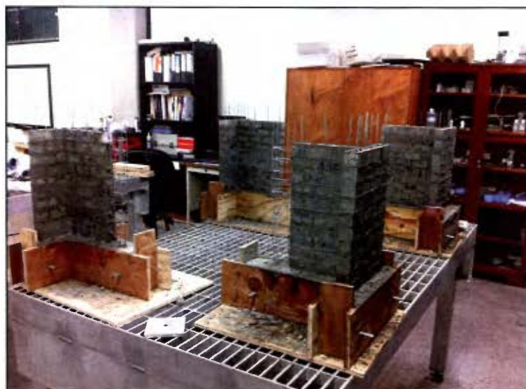
Figura 31. Paño de mampostería de los cuatro muros.
