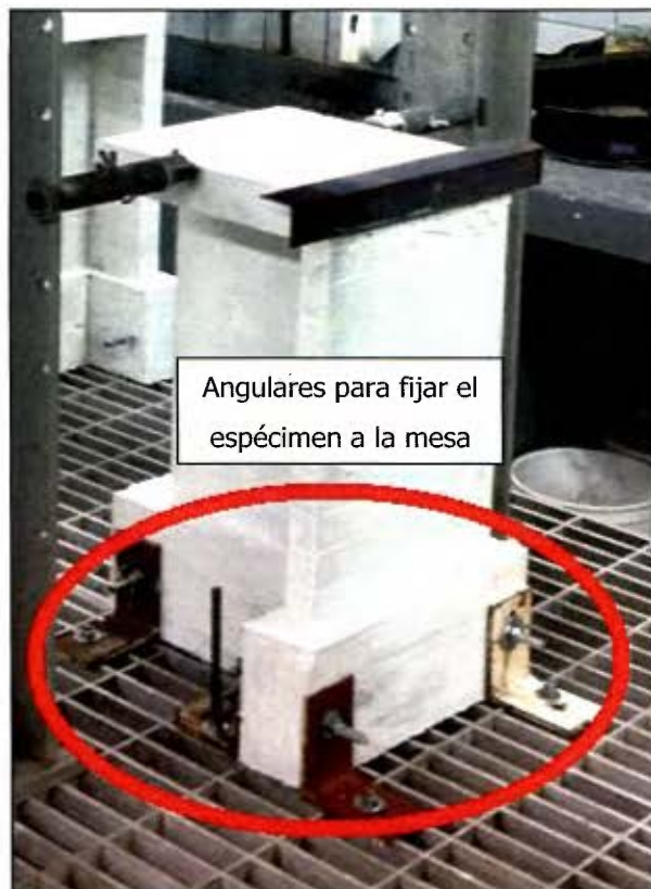
Figura 35. Muro colocado sobre la mesa de reacción.
