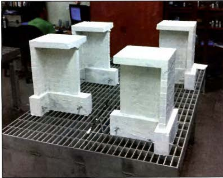
Figura 34. Muros desencofrados y pintados.
