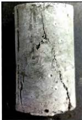
Figura 7. Falla de microcilindro de concreto.
