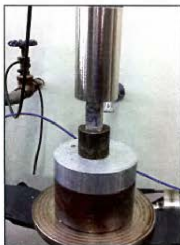
Figura 9. Muestra de microconcreto de relleno durante la falla.
