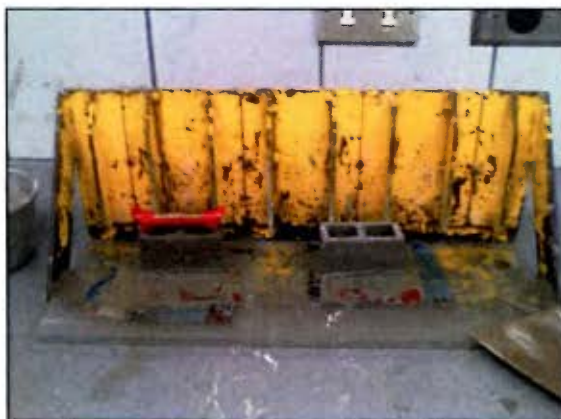
Figura 4. Coronamiento de los bloques.
