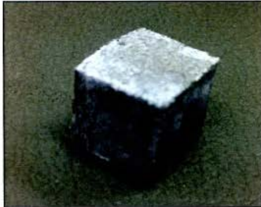
Figura 11. Cubo de mortero después de su falla.
