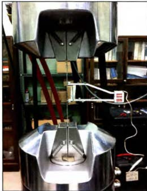
Figura 14. Ensayo a tensión del alambre galvanizado.
