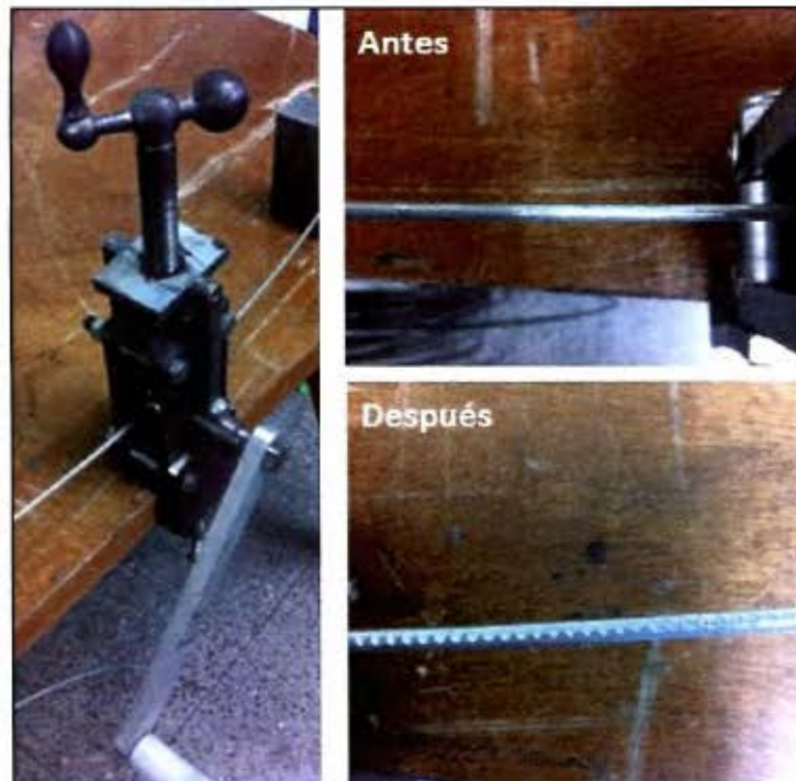
Figura 13. Máquina de corrugación y el alambre antes y después del proceso de corrugación.
