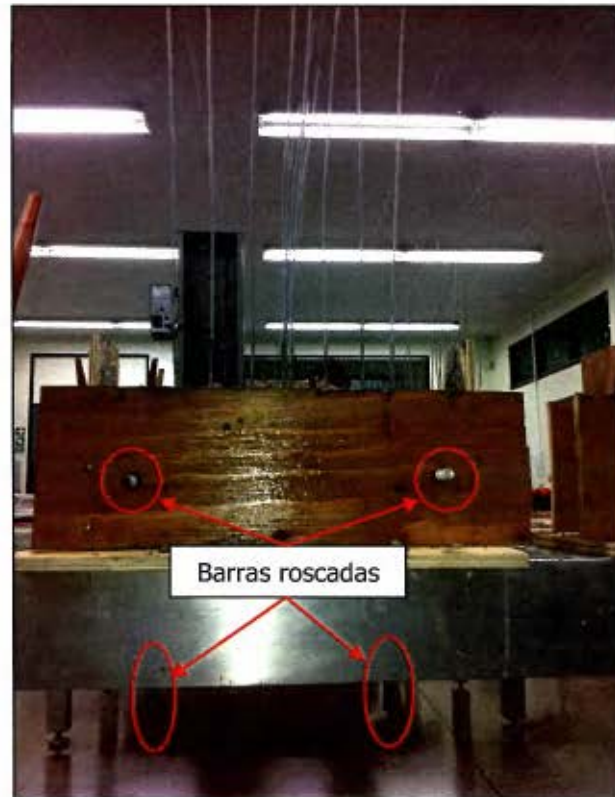
Figura 21. Barras roscadas embebidas de la fundación.
