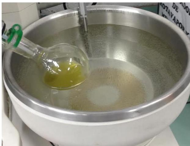
**Figura 2.5.** Equipo de destilación (rotavapor) en operación.
