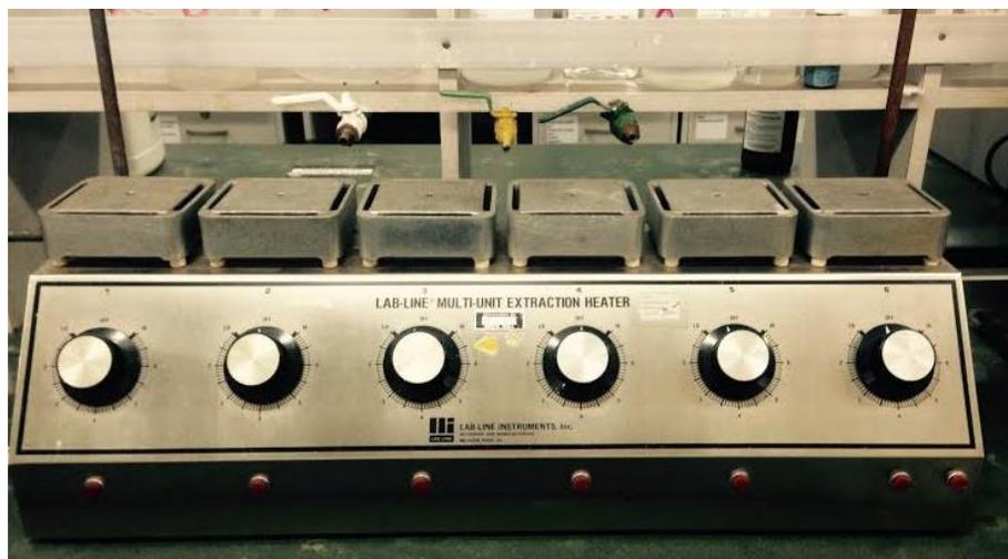
**Figura 2.4.** Calentador para extractor Soxhlet con solventes.
