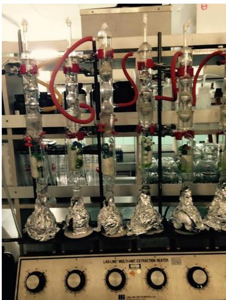
**Figura 2.3.** Equipo utilizado en operación para llevar a cabo la extracción de aceite esencial por medio de equipo Soxhlet.
