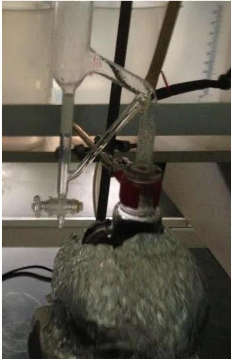
**Figura 2.6.** Equipo utilizado en operación para llevar a cabo la extracción de aceite esencial por medio arrastre con vapor.
