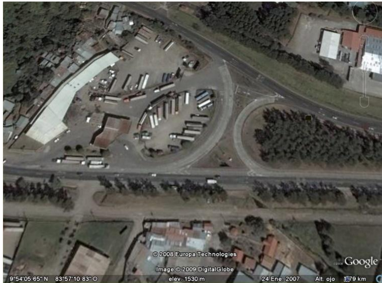
Figura 5.10 Vista aérea de los lazos de giro en U, Bomba Cristo Rey (final tramo 7).
