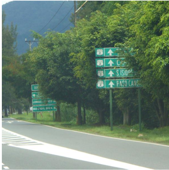
Fotografía 7.21 Señalamiento cubierto de manera parcial por vegetación.
