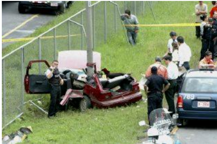
Figura 7.2 Accidente mortal con impacto a poste de iluminación.
