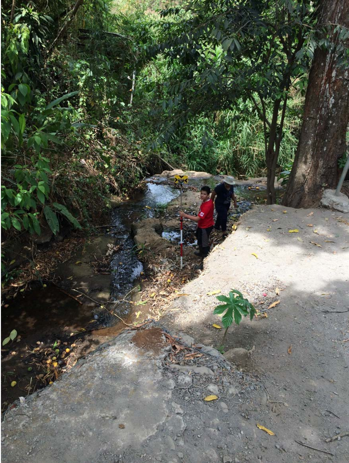
Figura 40. Levantamiento de las secciones transversales en la Quebrada Valverde (2)
