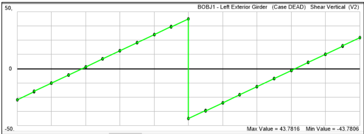
Figura F- 6. Diagramas V(x) , viga externa
