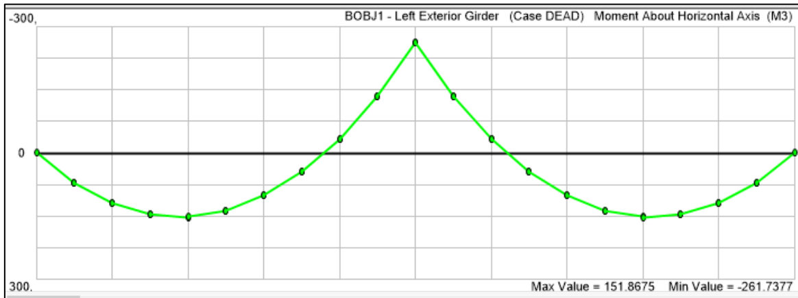
Figura F- 5. Diagramas M(x) , viga externa
