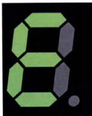
Figura 07. Sistema hexadecimal en siete segmentos
