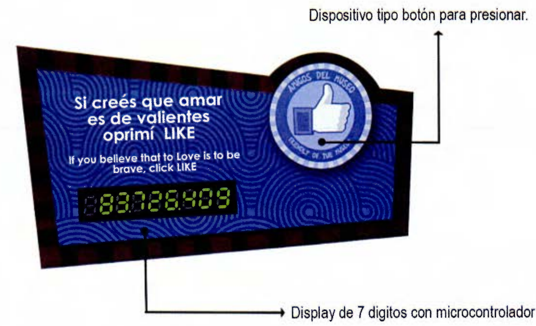
Figura 79. Esquema básico del dispositivo electrónico.
