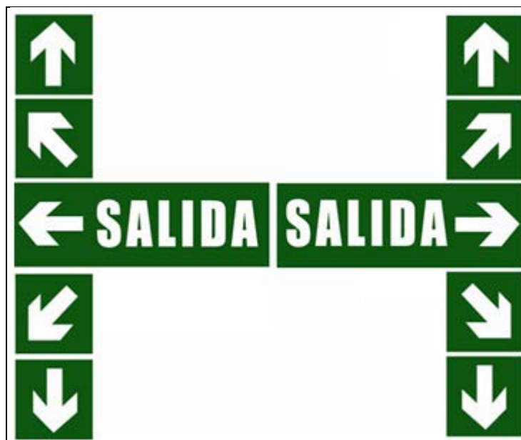
Figura 4.6 Señalización de tramos de recorrido de evacuación que conducen a salidas habituales. Fuente: INTE 21-02-02-96
