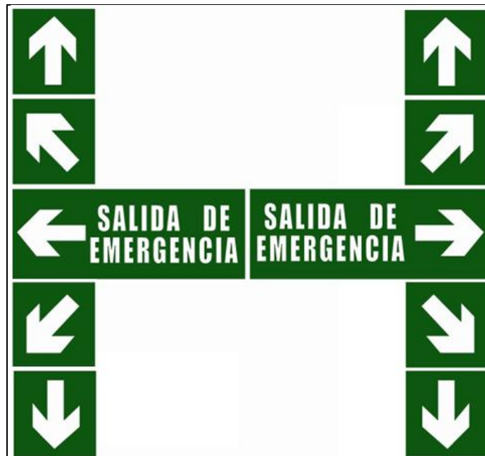
Figura 4.9 Señalización de tramos de recorrido de evacuación que conducen a salidas de emergencia.
