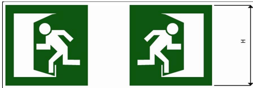
Figura 4.3 Señalización de salidas de emergencia Pictograma 4 (P-4). Fuente: INTE 21-02-02-96
