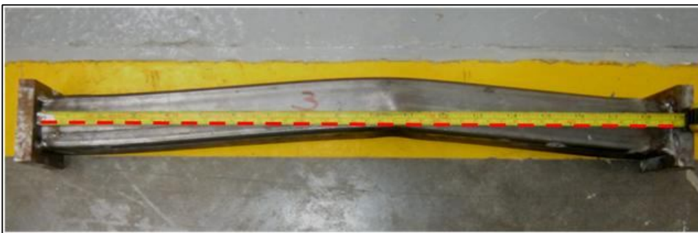
Figura 6.8. Pandeo global típico. Especimen 3 después de la falla.
