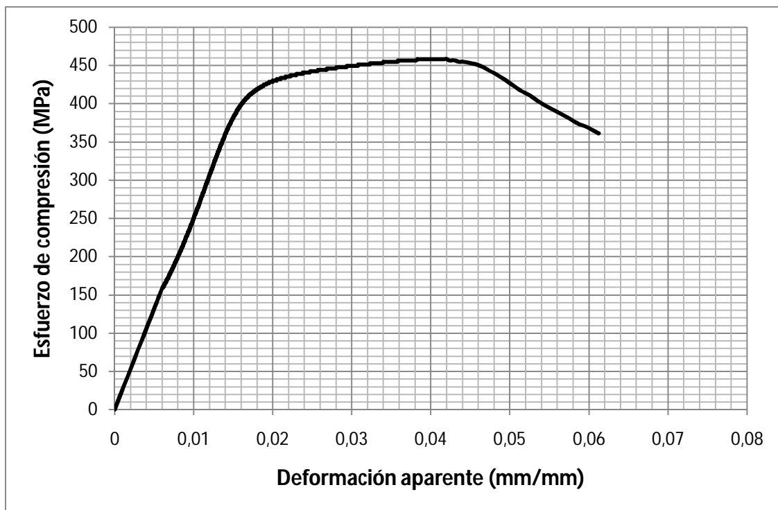
Figura F.6. Gráfico esfuerzo-deformación aparente, para el espécimen de columna corta 3.
