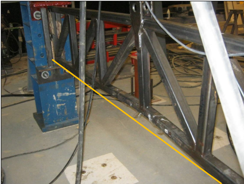
Figura 6.14. Deformación por pandeo en el espécimen C2-1.
