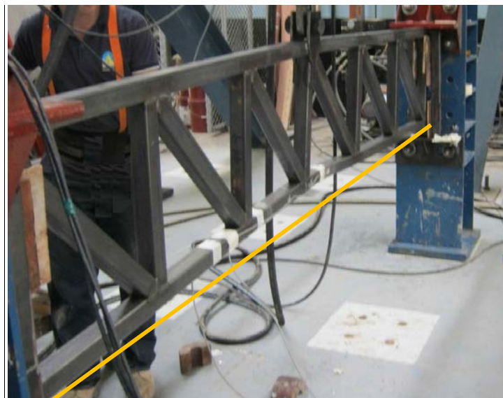
Figura 6.13. Deformación por pandeo en el espécimen C1-2.
