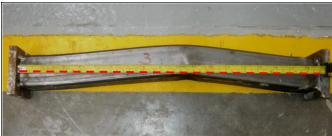
Figura G.6. Especimen 3 después de la falla.
