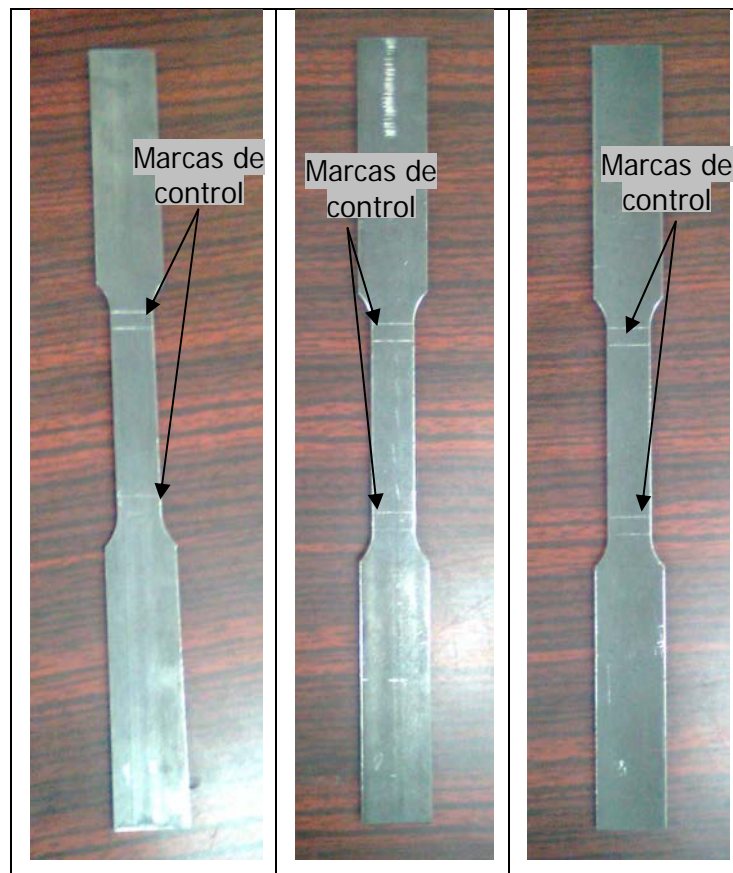
Figura 5.2. Probetas para el ensayo a tensión. De derecha a izquierda: Espécimen 1, Espécimen 2, Espécimen 3.
