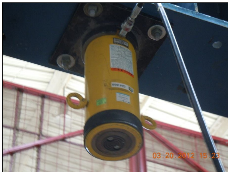
Figura 5.11. Gato hidráulico utilizado para realizar la carga a los especímenes
