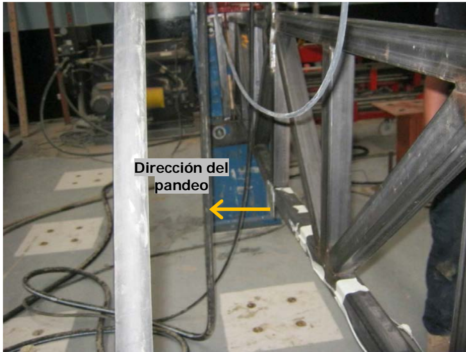
Figura 6.15. Deformación por pandeo en el espécimen C3-1.
