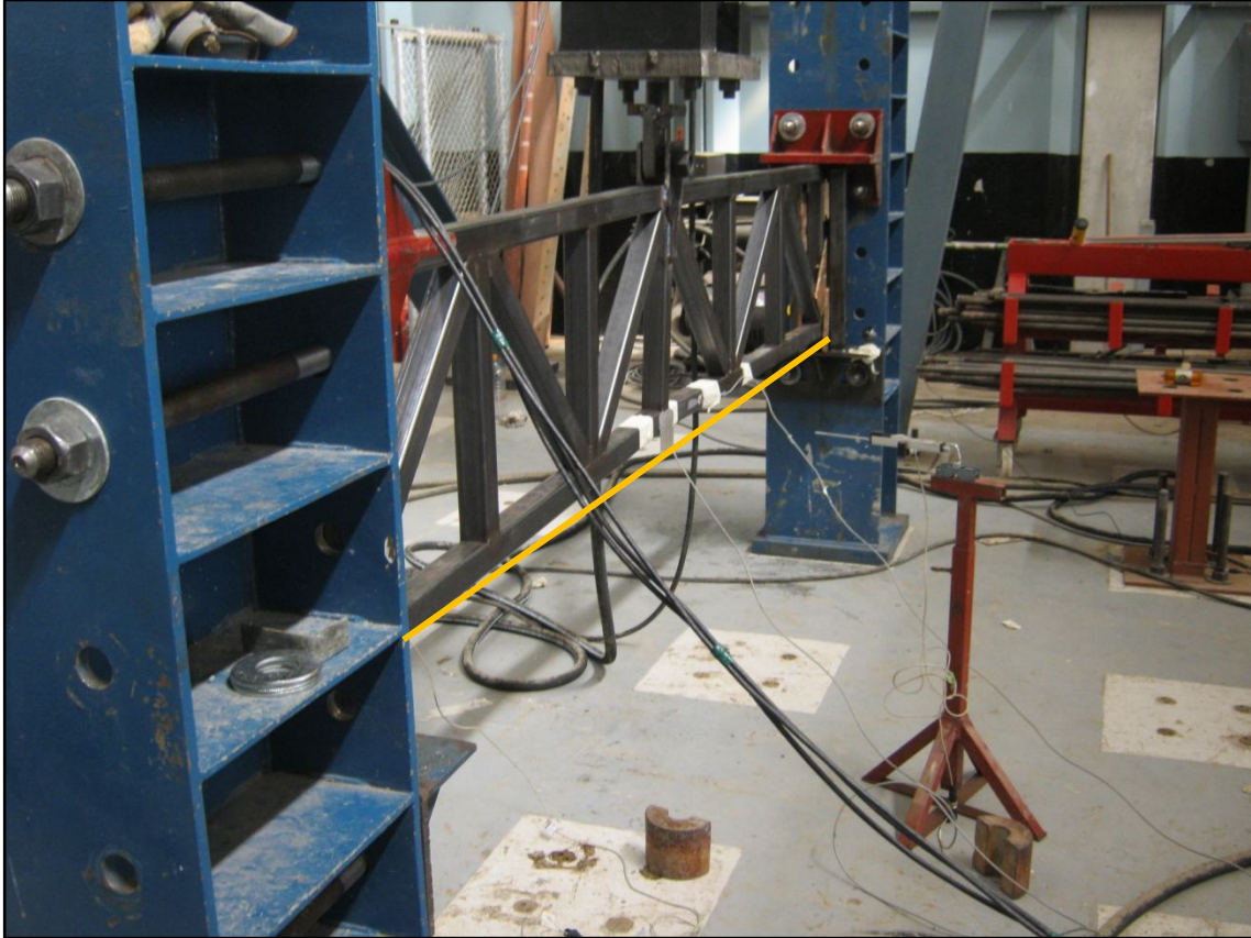
Figura 6.16. Deformación por pandeo en el espécimen C3-2.
