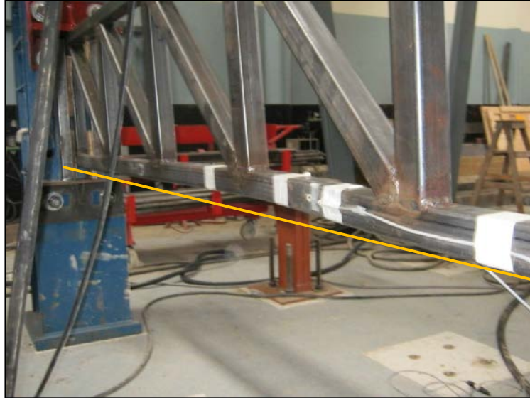
Figura 6.11. Deformación por pandeo en el espécimen C1-1.
