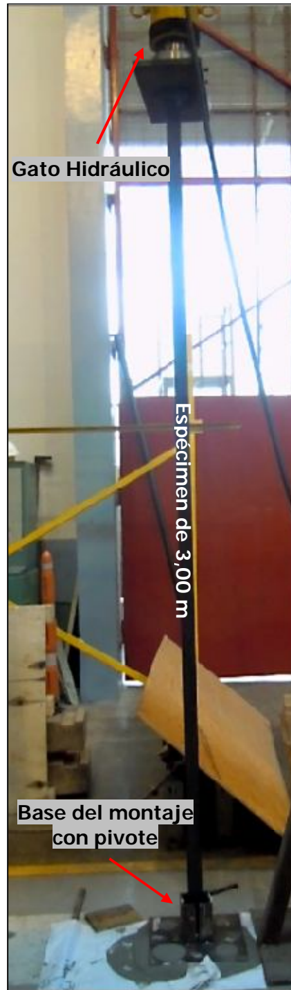
Figura 5.9. Montaje experimental y espécimen típico para el ensayo de especímenes representativos de la longitud sin arriostrar de las armaduras.
