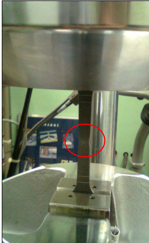
Figura 6.2. Modo de falla típico de las probetas de acero.
