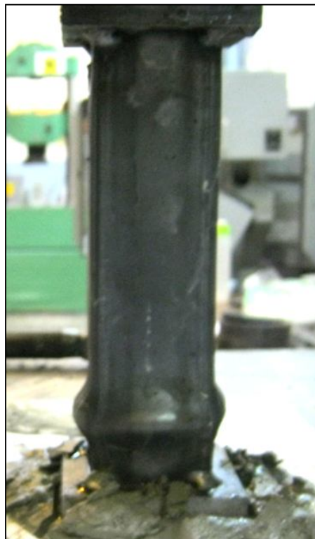
Figura 6.5. Modo de falla típico para los especímenes de columna corta. Se muestra el espécimen 1.
