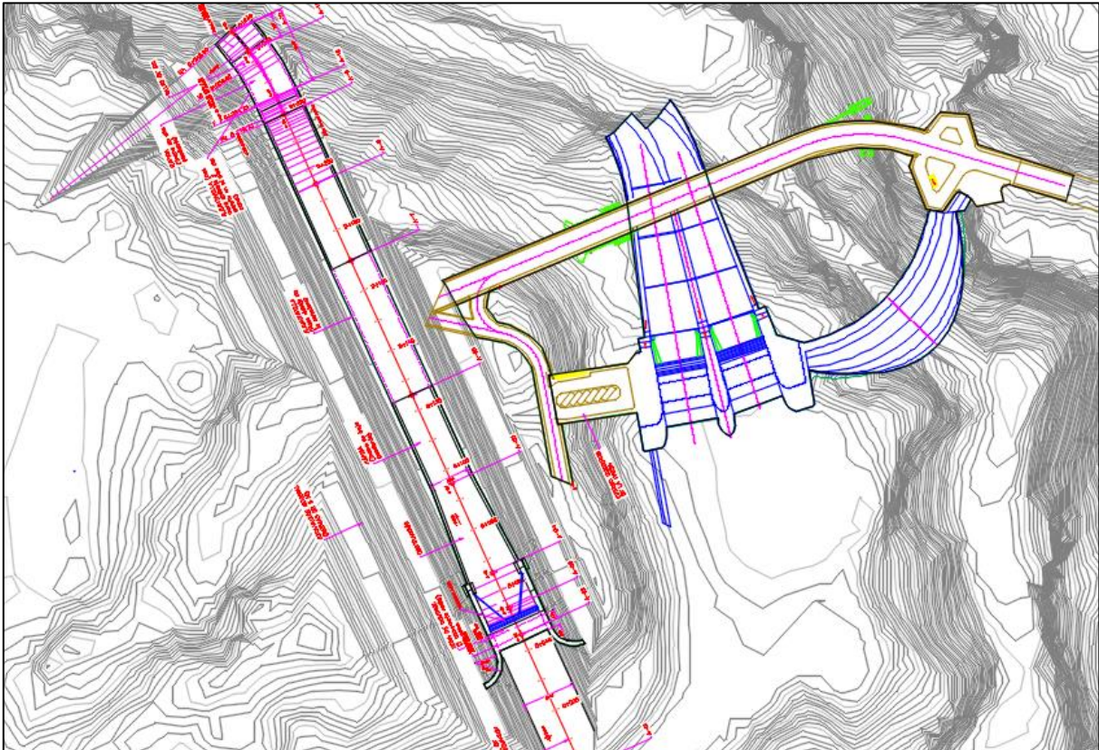
Figura 79. Alineamiento final del vertedero controlado
