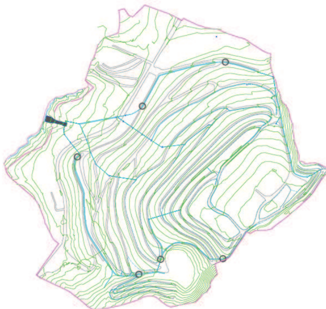
Figura 5.3. Obras existentes de pluviales Fuente: WPP
