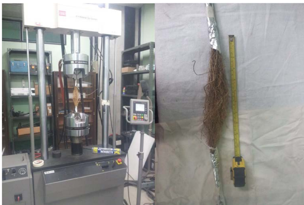
Figura 3.31 Montaje de los haces de raíces en la máquina MTS (izquierda), espécimen de raíces listo para la falla
