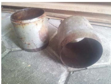
Figura 3.18 Moldes de CBR modificados en el LANAMME
