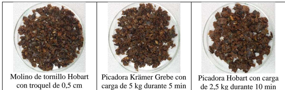
Nótese cómo de manera general los tamaños de los trozos de pulpa obtenidos tras la trituration con el molino de tornillo y la picadora Krämer Grebe son menores a los obtenidos con la picadora Hobart en las condiciones aplicadas. A partir de lo anterior, considerando la capacidad del molino para el procesamiento de muestras independientemente del tamaño de la carga, así como la facilidad de uso y homogeneidad
