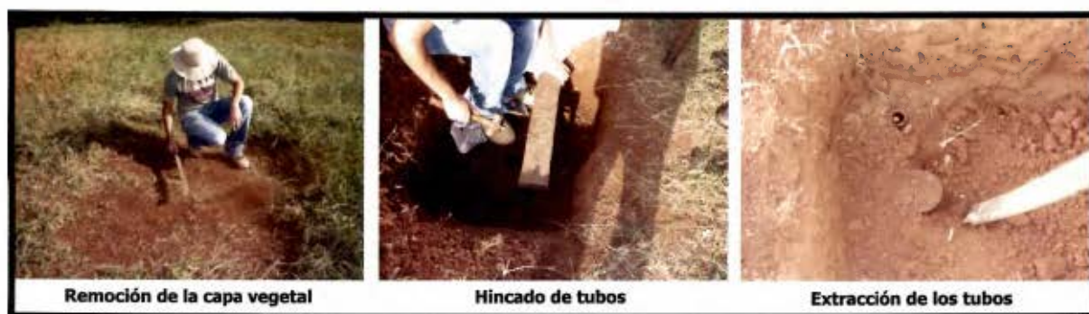
Figura 4.2. Proceso de extracción de muestras inalteradas con tubos de pared delgada.
