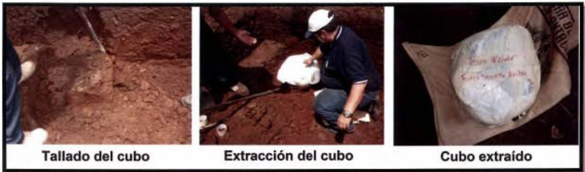
Figura 4.3. Proceso de extracción de un cubo de muestra inalterada.
