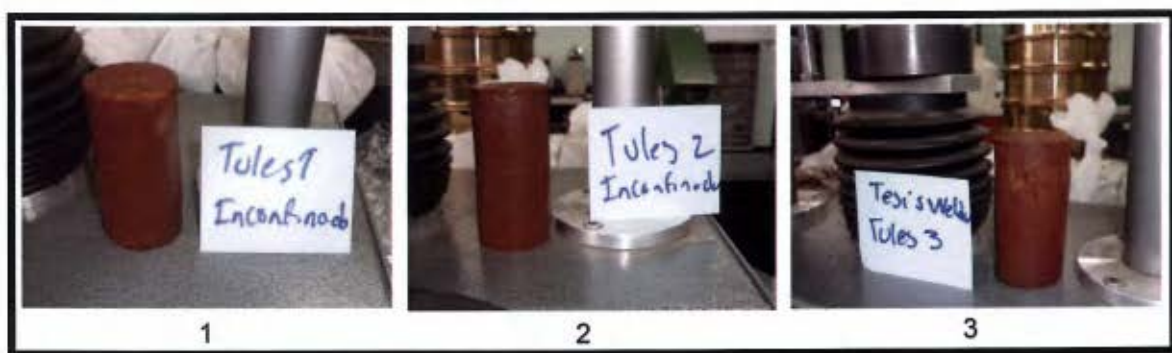
Figura G.4. Especímenes usados en compresión inconfiada después de la falla, sitio Tules.
