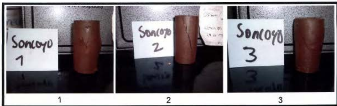
Figura G.3. Especímenes usados en compresión inconfiada después de la falla, sitio Soncoyo.
