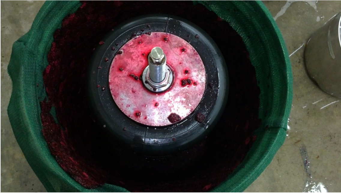
Figura 1. Hidroprensa para el prensado de manera discontinua de mora.
