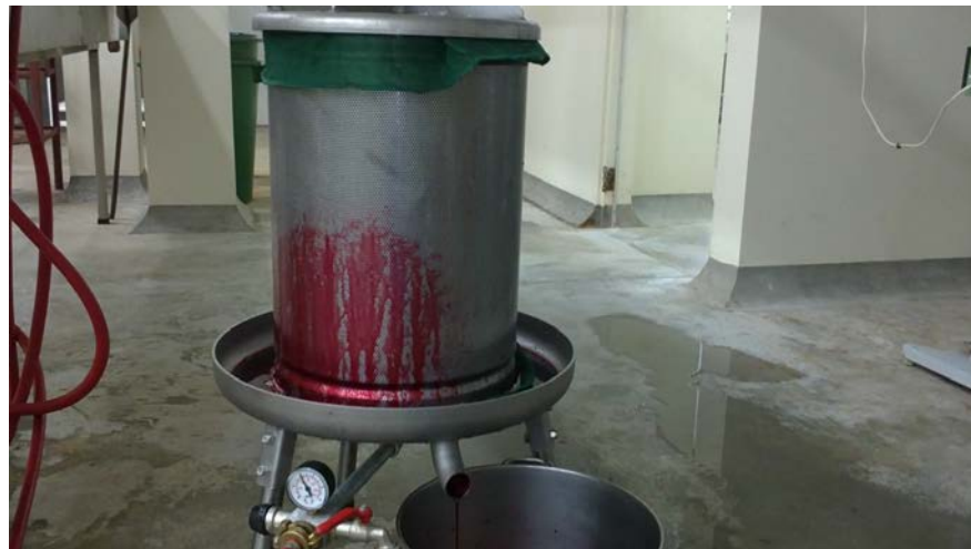
Figura 10. Hidroprensa de la marca Enotecnica Pillan, modelo Carezza.
