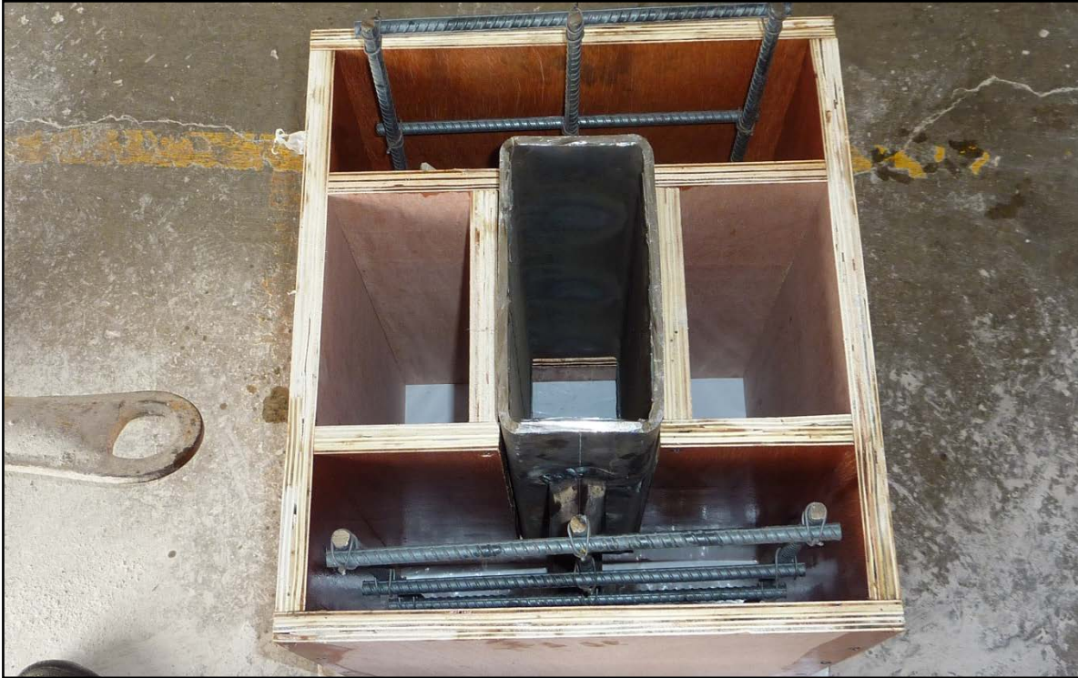
Figura 3.10: Espécimen listo para la chorrea del concreto.
