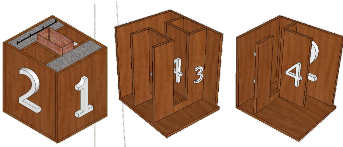
Figura 3.6: Preparación de la formaleta.
