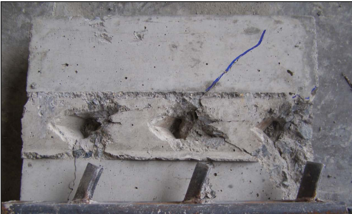
Figura 4.3: Cono de concreto. Espécimen 25.4 X 25.4 X 6.35 – 02.
