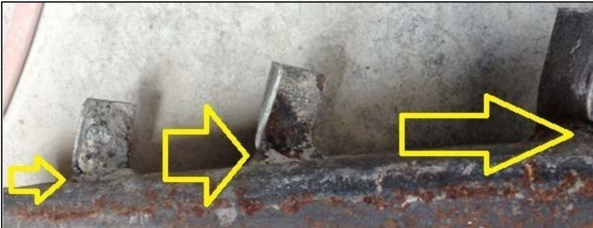
Figura 4.5: Ruptura del material base. Espécimen 31.75 X 31.75 X 3.18 - 01.
