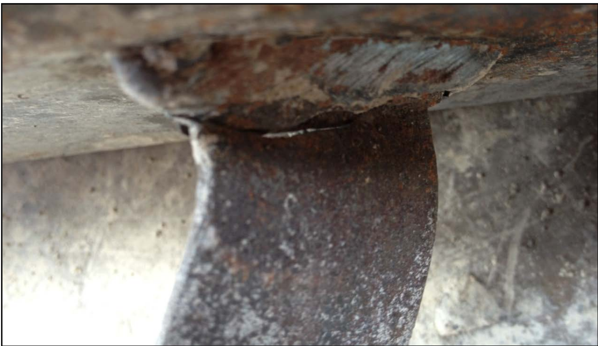
Figura 4.6: Ruptura del material base. Espécimen 25.4 X 25.4 X 6.35 - 01.
