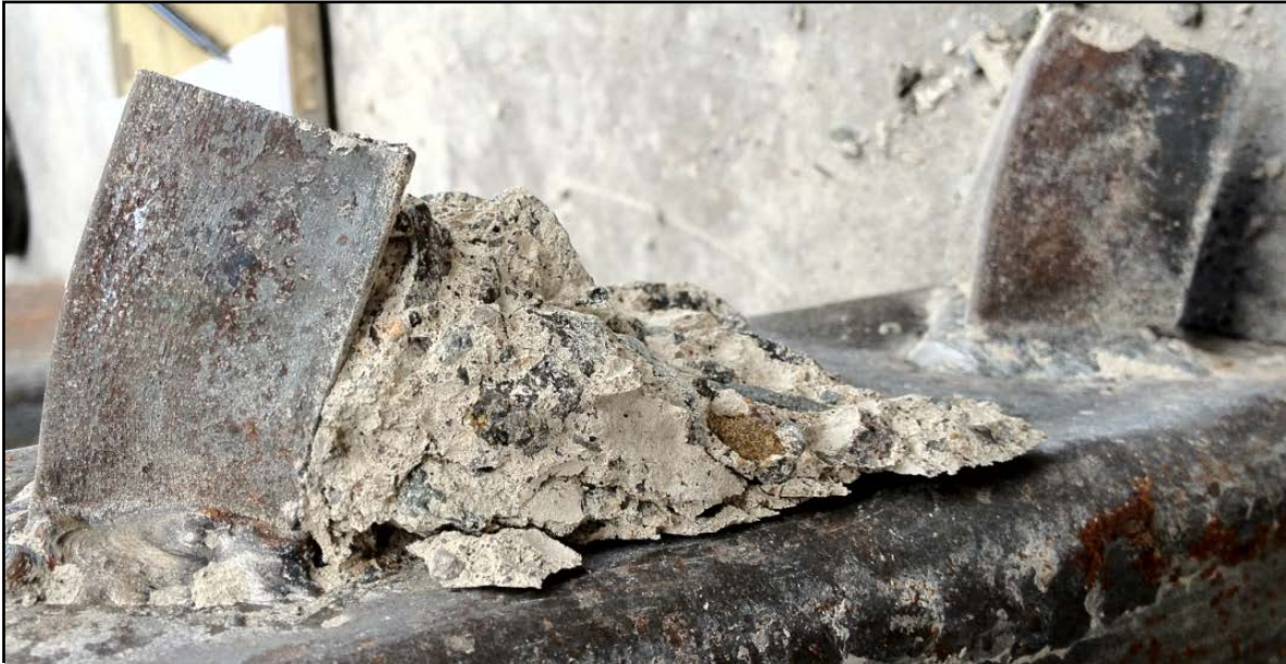
Figura 4.2: Cono de concreto. Espécimen 31.75 X 31.75 X 3.18 – 02
