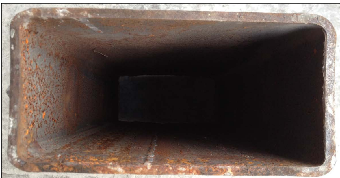
Figura 4.7: Sección HSS tras la falla. Espécimen 31.75 X 31.75 X 3.18 – 03.
