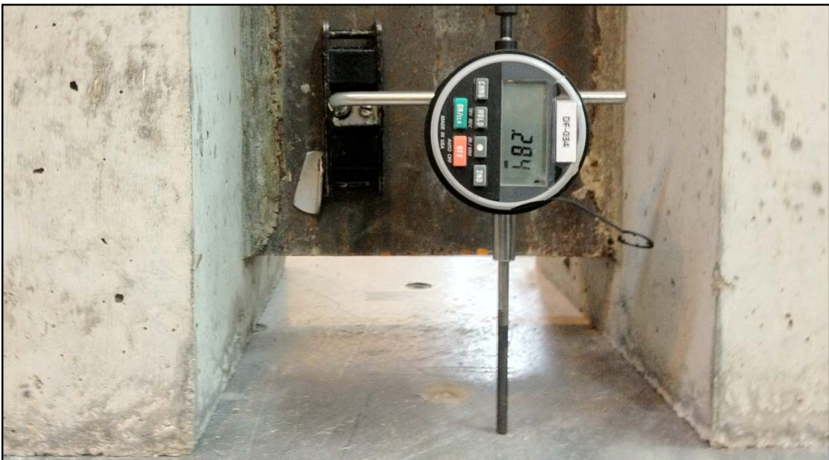
Figura 3.14: Ubicación del deformímetro.
