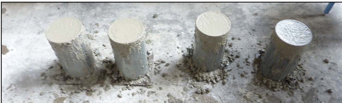
Figura 3.12: Colada de cilindros de concreto para obtener resistencia del concreto.
