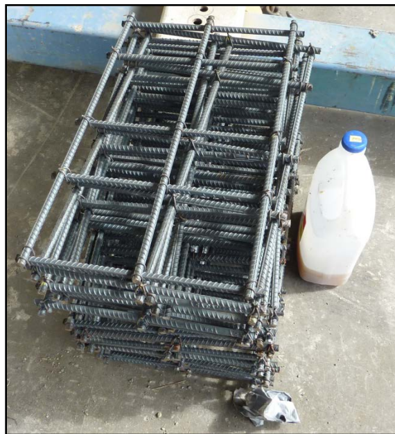
Figura 3.5: Armadura de refuerzo de sección de concreto.
