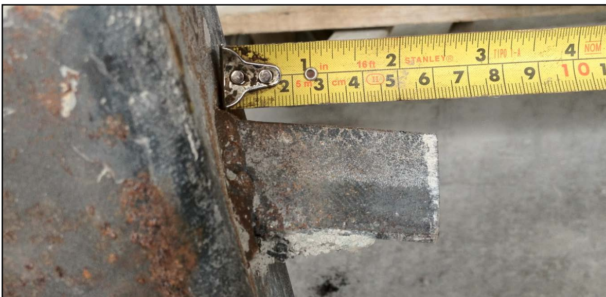
Figura 4.4: Leve deformación en el angular. Especímen 31.75 X 31.75 X 4.76 – 03.
