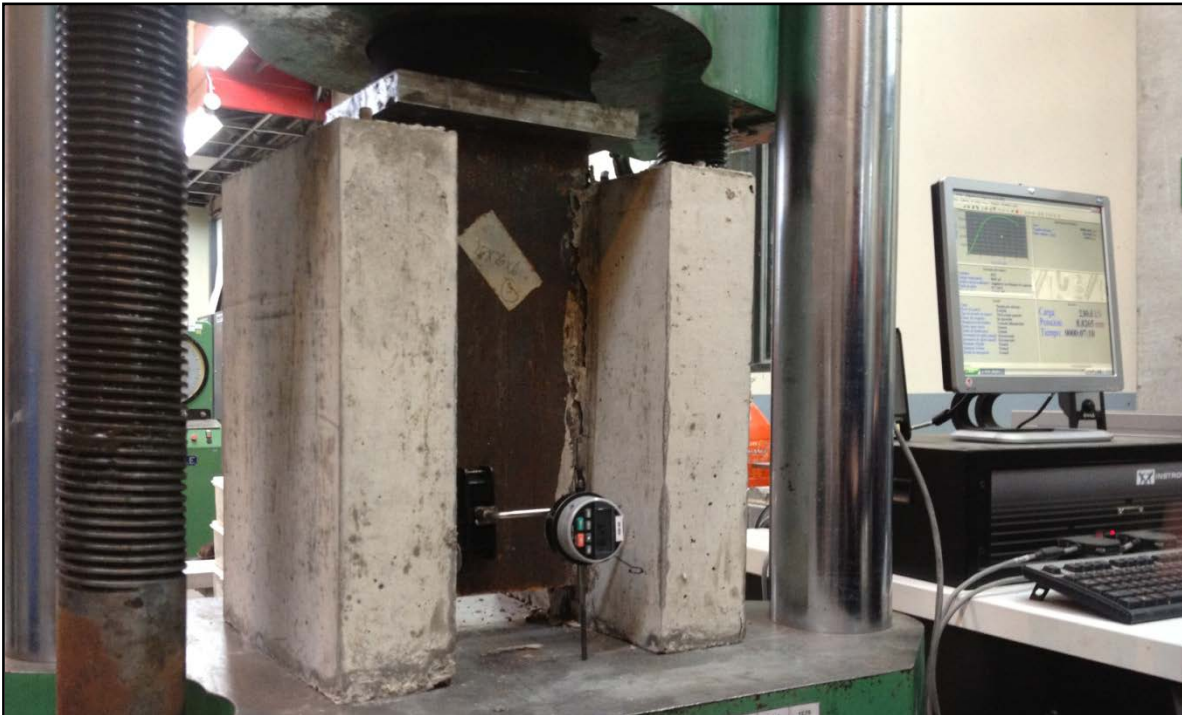
Figura 3.13: Proceso de falla de los especímenes.
