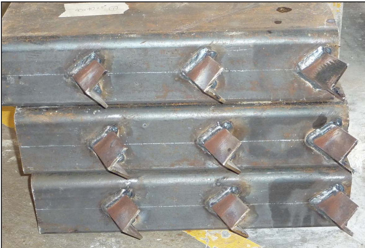
Figura 3.3: Secciones con angulares soldados para especímenes 38.1 X 38.1 X 4.76.
