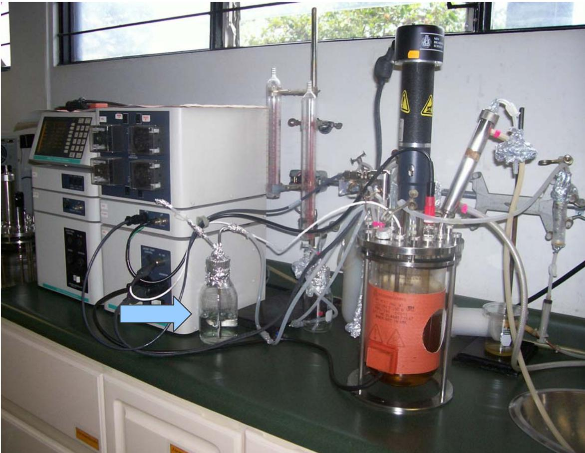
Figura 10. Equipo de fermentación con trampa de agua adaptada al sistema.
