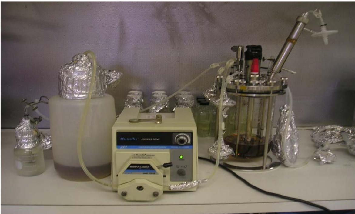
Figura 6. Proceso de alimentación del bioreactor con los distintos componentes del medio de fermentación.
