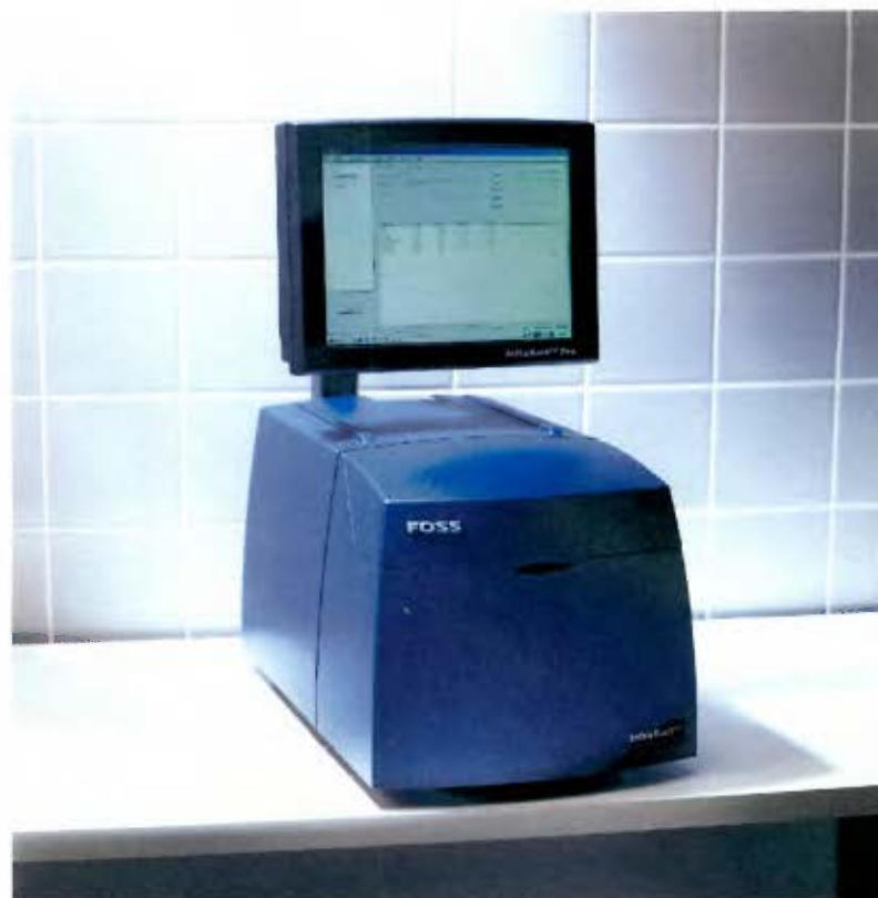
Figura 7.2 Equipo NIR con pantalla táctil integrada para ser utilizado al lado de la línea de producción [Foss analytical,2007]
