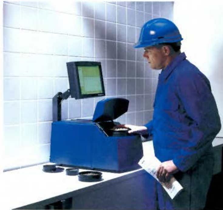
Figura 2.5. Equipo NIR Infraxact utilizado en ese estudio, instalado de acuerdo a los requerimientos de instalación mencionados en el Cuadro 2.1
