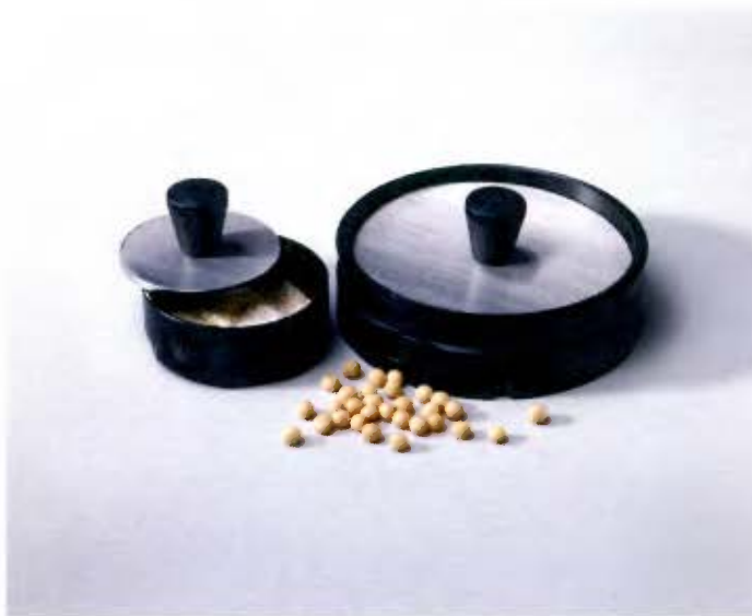
Figura 7.1. Celda para producto molido del equipo NIR (izquierda) y tapa para compactar la muestra. [Foss analytical,2007]
