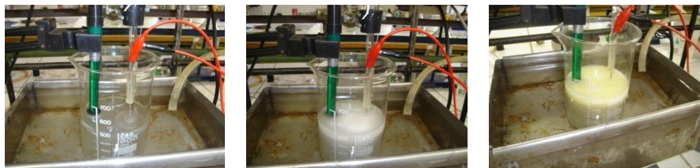
Figura 5.2 Avance de la electrólisis de una disolución de EDTA-Hueso.
