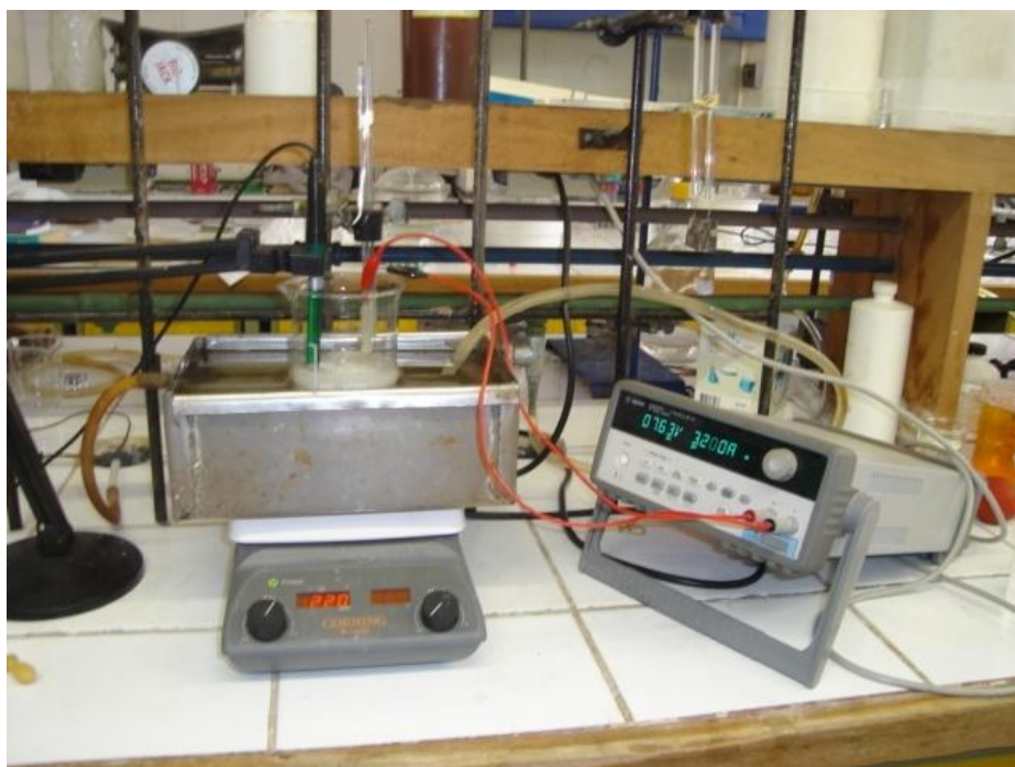
Figura 4.1 Equipo experimental para la etapa de electrólisis.
