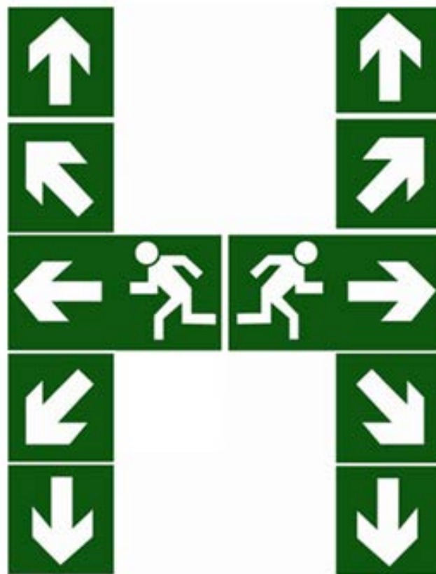
Figura VII.8. Señalización de tramos de recorrido de evacuación que conducen a salidas de emergencia.
