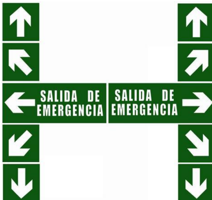
Figura VII.9. Señalización de tramos de recorrido de evacuación que conducen a salidas de emergencia.
