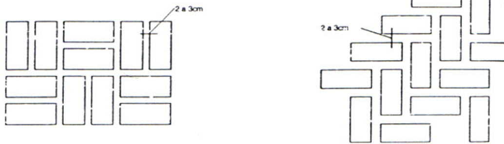
Figura 8.11. Arreglos de ladrillos para lechos de secado
