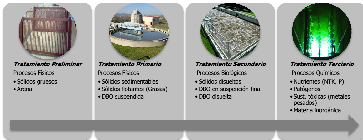
Figura 3.6. Esquema general de los sistemas de tratamiento, tipo de procesos y parámetros de remoción.
