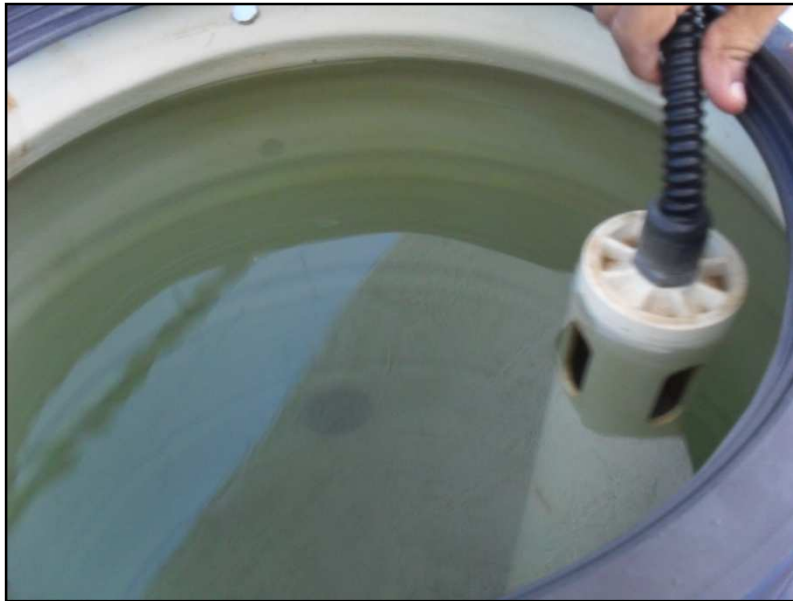
Figura 13. Equipo que utiliza hipoclorito de sodio
