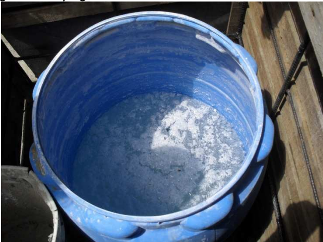
Figura 3. Estación con mezcla de hipoclorito de calcio granulado y agua.
