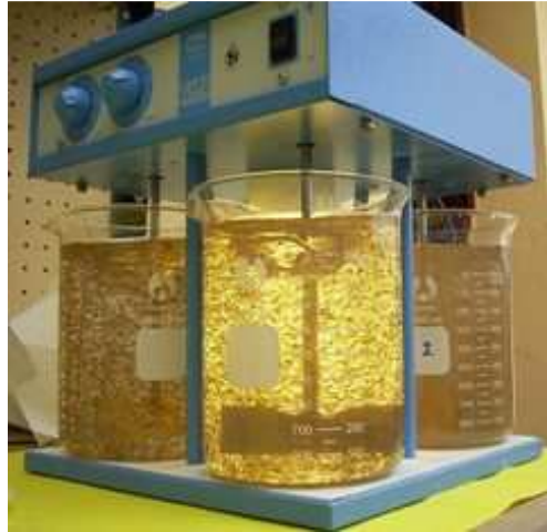
Figura 7. Equipo para la prueba de jarras.
