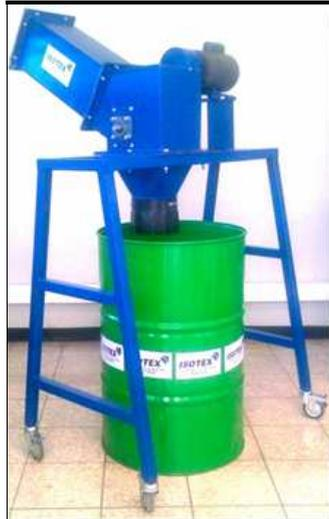
**Figura 5.6.** Trituradora de Vidrio, Isotex
